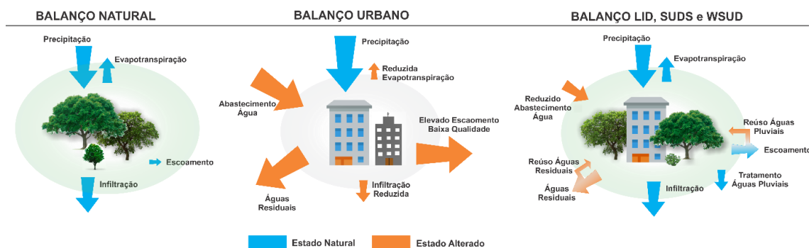
Figura 4 - Ilustração do balanço de água no ambiente urbano com e sem integração das abordagens LID, SUDS e WSUD.
