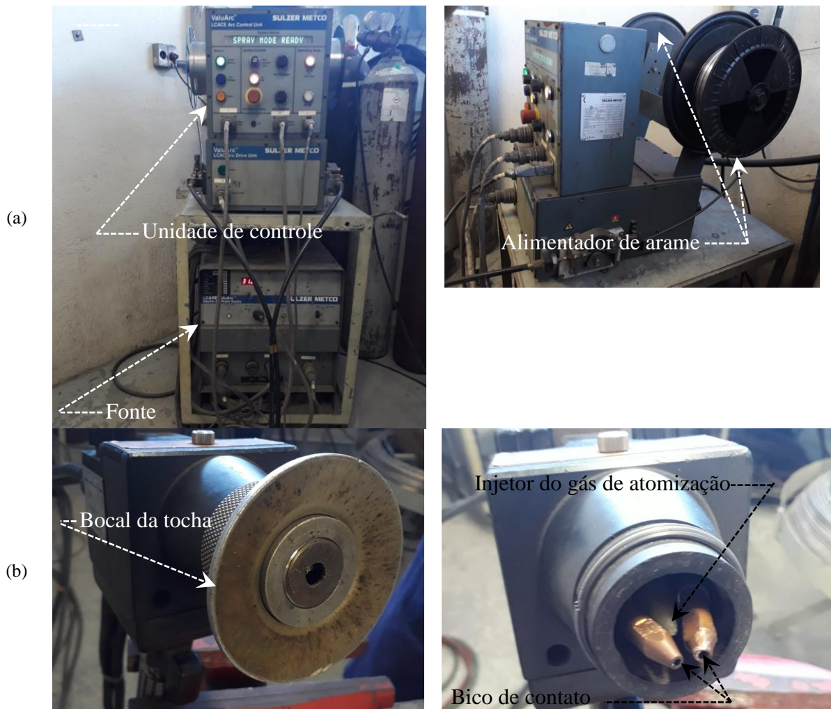
Figura 10. (a) Equipamento de aspersão térmica a arco elétrico; (b) Pistola de aspersão térmica a arco elétrico.
