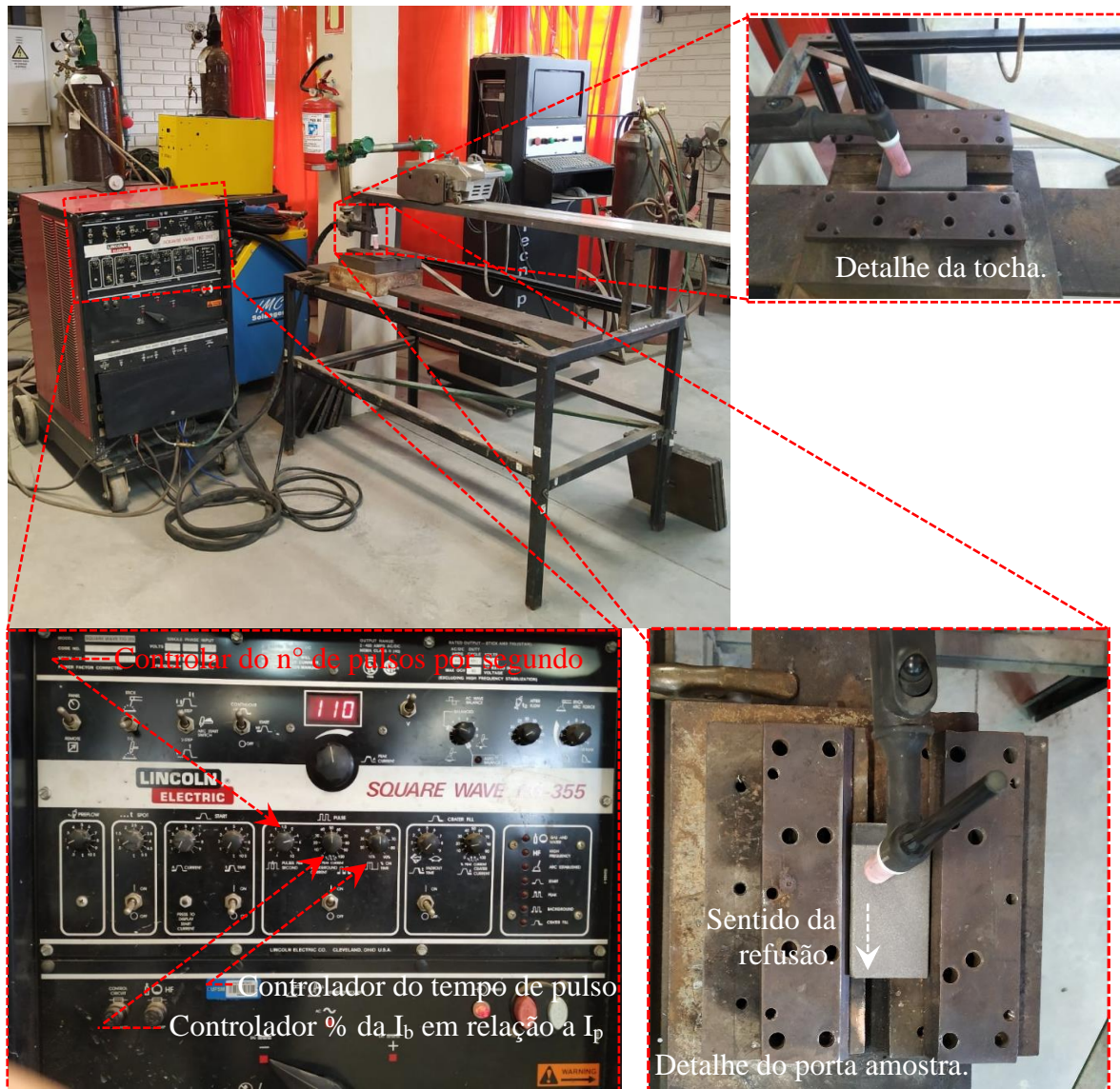
Figura 11. Equipamentos empregados para realizar a refusão dos revestimentos aspergidos termicamente.
