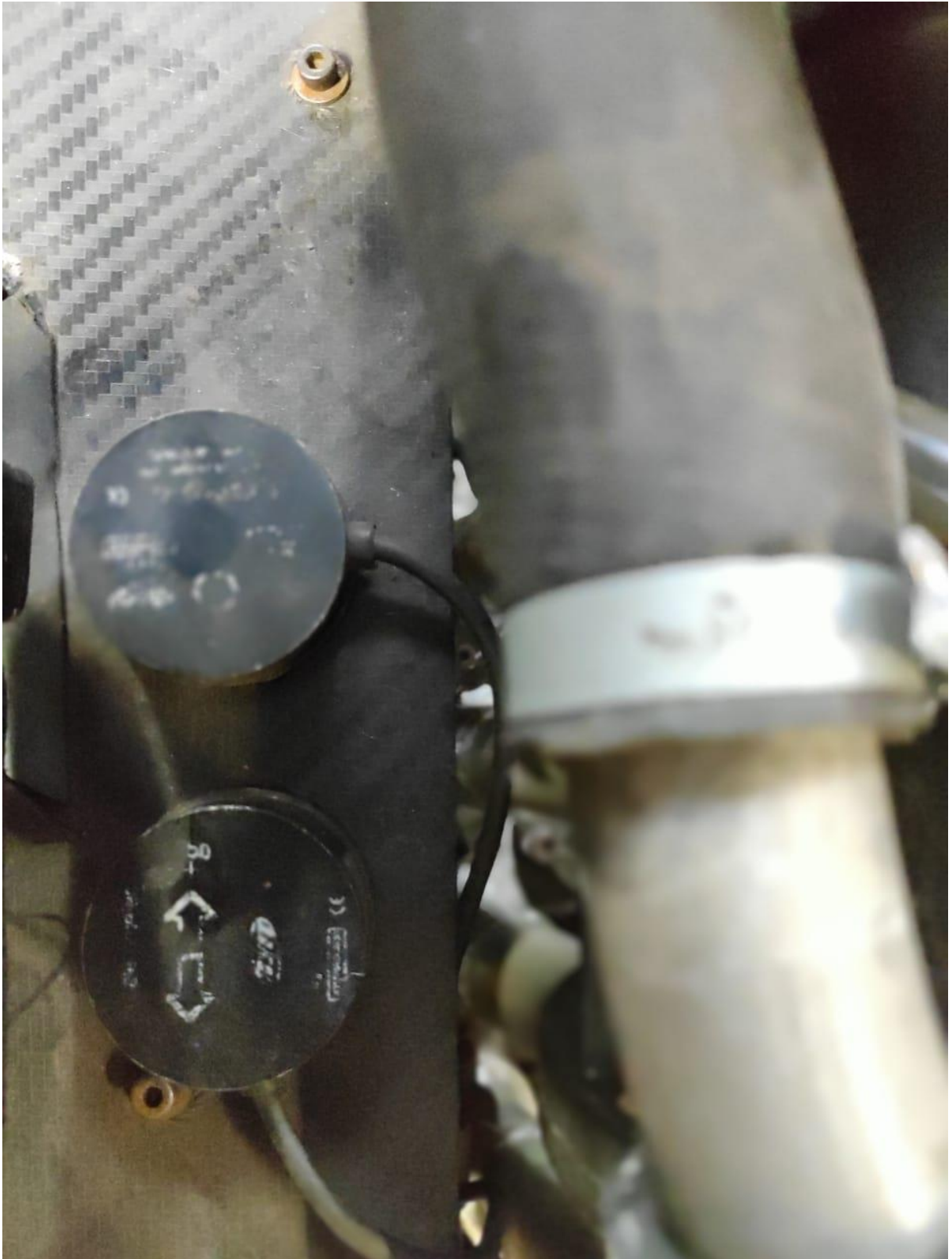
(ACELERÔMETRO UNIAXIAL E GIROSCÓPIO INSTALADOS NO PROTÍTIPO FU19)
