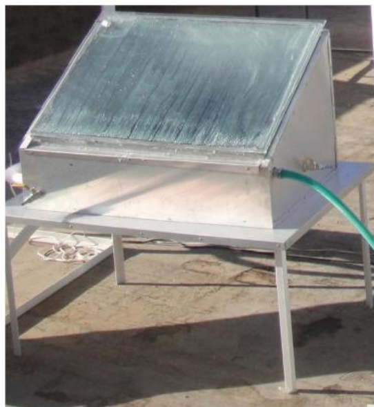
Figura 3 – Exemplo de um destilador convencional de única inclinação (Irã)
