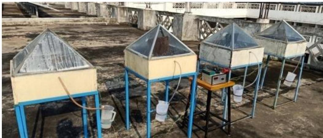
Figura 5 – Exemplo de uma série de destiladores solares do tipo piramidal, para teste de melhor isolante térmico (Índia)
