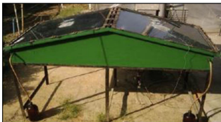
Figura 4 – Exemplo de um destilador de dupla inclinação (Índia)
