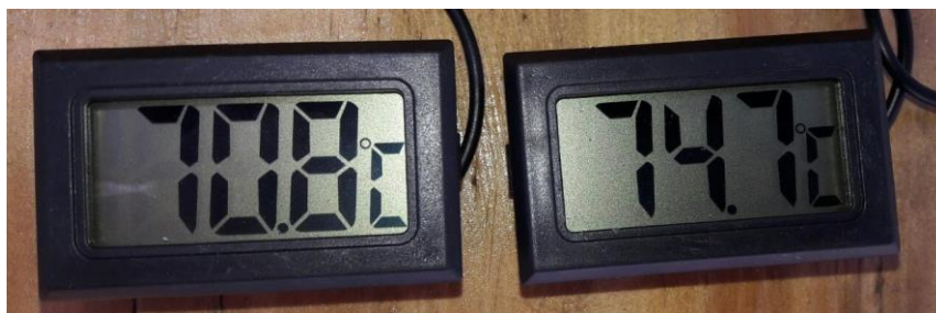
Figura 19 – Temperaturas medidas da água bruta (esquerda) e do ar interno do destilador (direita)
