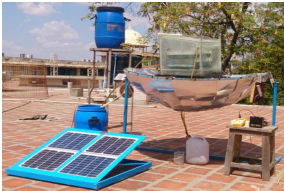
Figura 7 – Exemplo de um destilador híbrido com placa fotovoltaica (Índia)
