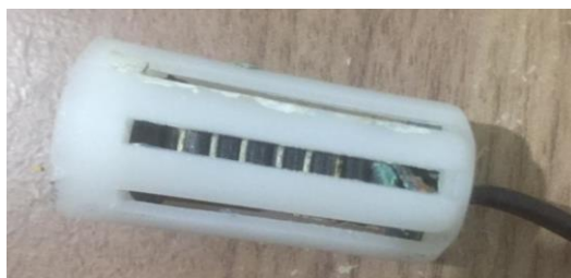
Figura 16 – Foto da resistência elétrica usada no sistema de aquecimento com 3,5 cm de nível de água
