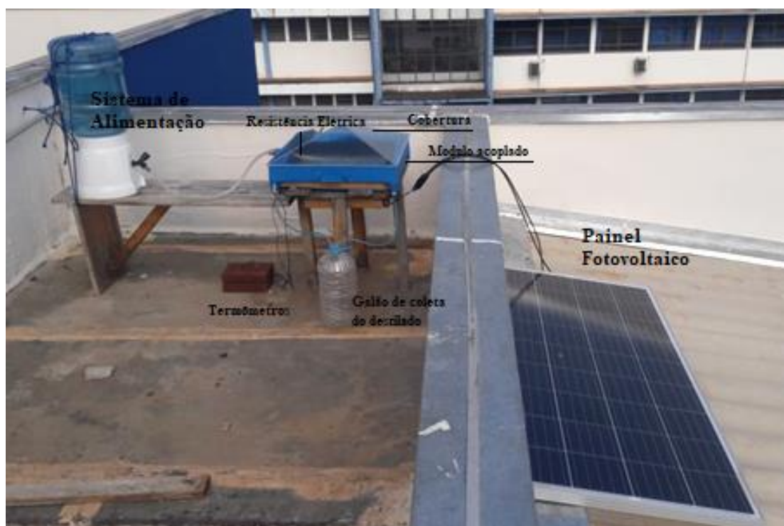
Figura 18 – Foto do sistema completo do destilador solar piramidal
