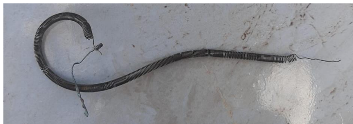
Figura 17 – Foto da resistência elétrica usada no sistema de aquecimento com 1,0 cm de nível de água
