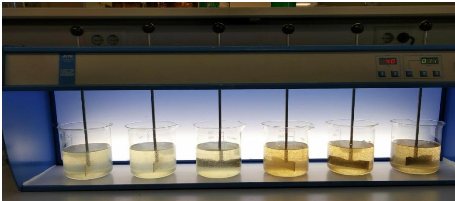
Figura 3 - Ensaio de coagulação/floculação utilizando sulfato de alumínio e tanino.
