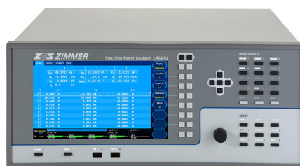
Figura 2.2 – Analizador de energia ZIMMER LMG670
