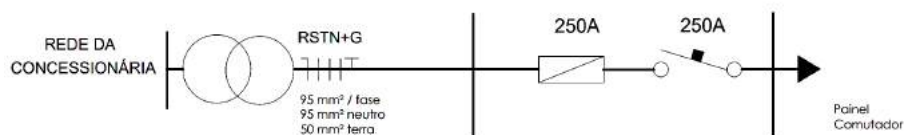
Ilustração 3.5 – Diagrama unifilar Ramal Ligação
