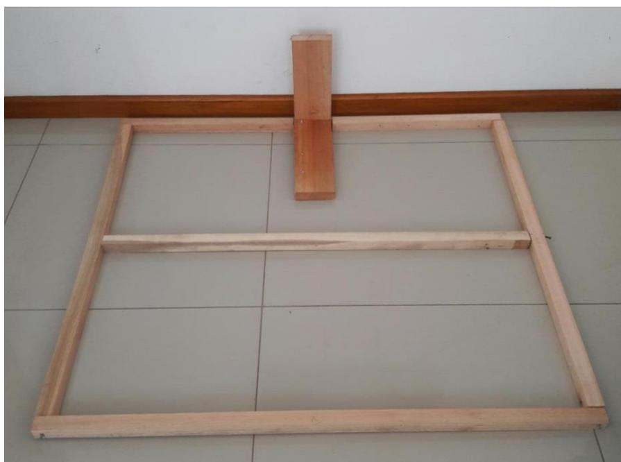
A montagem da base foi realizada a partir dos materiais do projeto e sua fixação por meio de parafusos.
