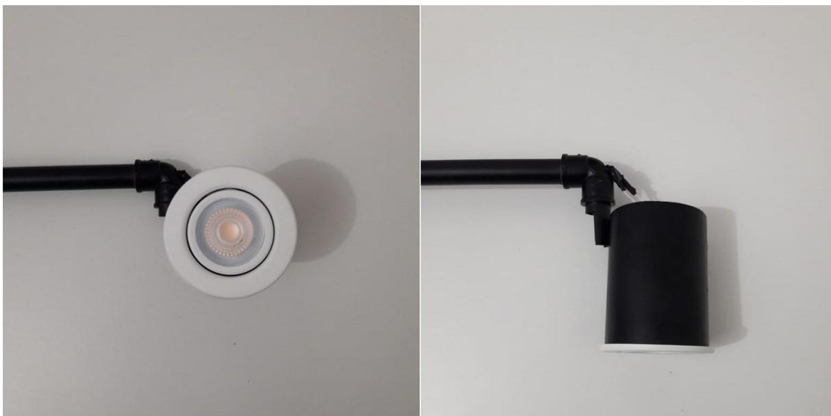
A estrutura da luminária permite a movimentação da luminária, tanto em altura quanto em mudança de ângulo, além da passagem dos condutores para acionamento da lâmpada. A fixação da estrutura ao resto da bancada se deu por meio de parafusos.
