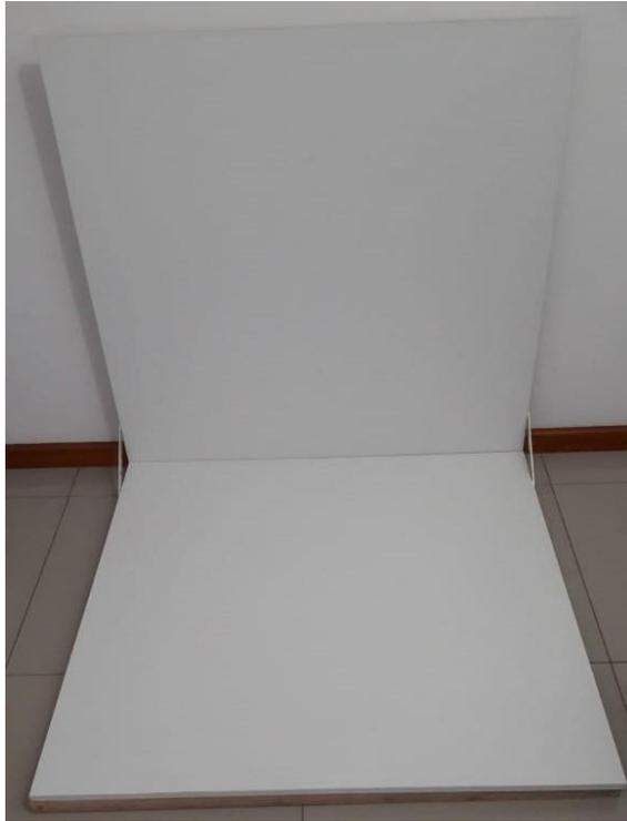
A fixação do corpo da bancada à base foi feita por meio de parafusos, além de dois suportes de 10 cm entre os anteparos para uma melhor estabilidade, como demonstrado a seguir:
