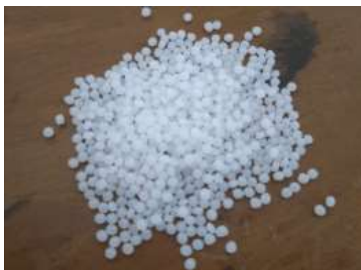
Figura 11 – Aspecto do polietileno verde de alta densidade utilizado como matriz
