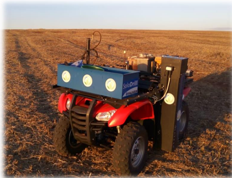
Figura 2: Quadriciclo com trado de rosca utilizado na coleta das amostras de solo.
