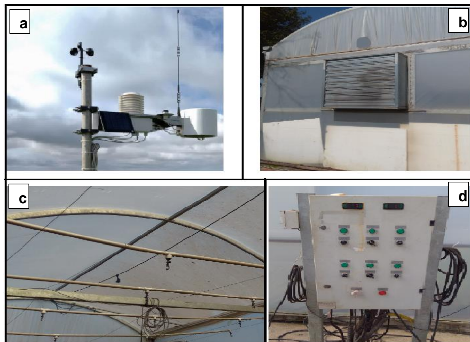
Figura 12 - Estação meteorológica a campo (a), controle de pluviosidade/umidade-casa de vegetação (b, c), comando geral das funções (d).
