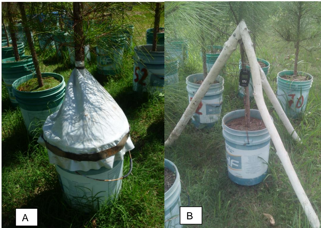
Figura 3 - Cobertura plástica usada durante o tratamento de seca (A). Pesagem usando tripé e dinamômetro(B).
