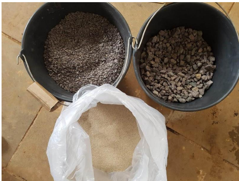
Figura 18 – Materiais selecionados utilizados nas colunas de filtração.
