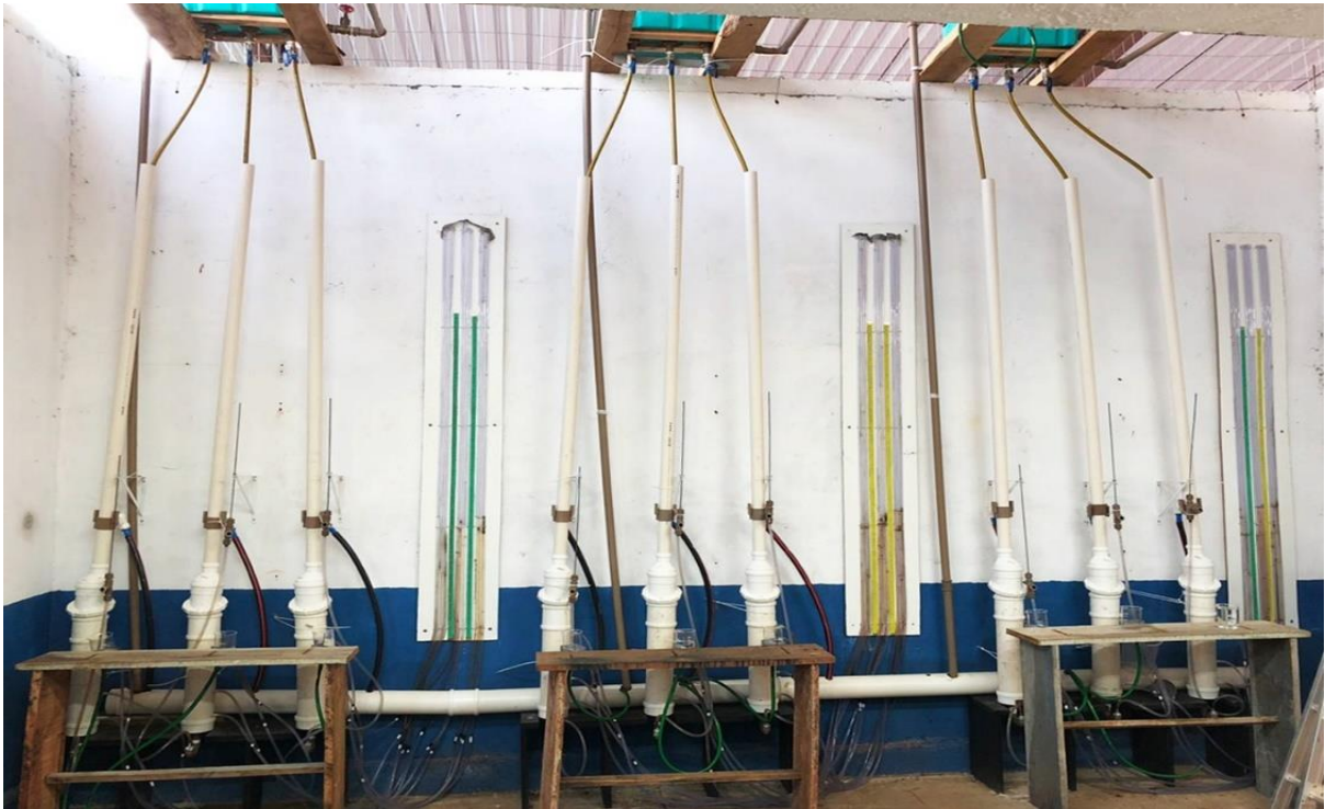
Figura 16 – Conjunto de colunas de filtração.
