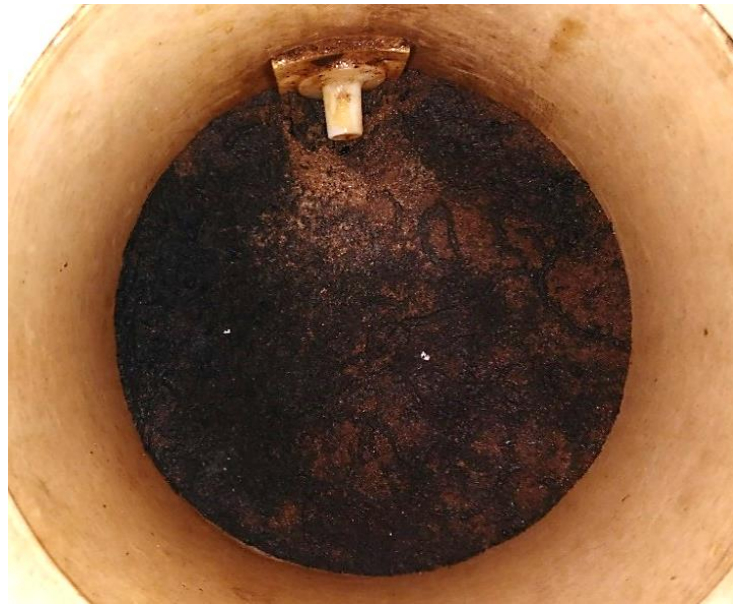
Figura 20 – Visão da colmatação externa do meio filtrante.
