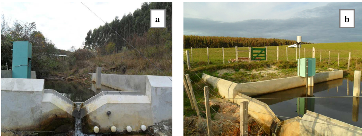
Figura 20. a) Vertedor situado na bacia com plantio de eucalipto na Fazenda Horto Florestal Ponta das Canas, b) Vertedor situado na bacia de campo com Pastagem na Fazenda Alvorada, São Gabriel-RS.
