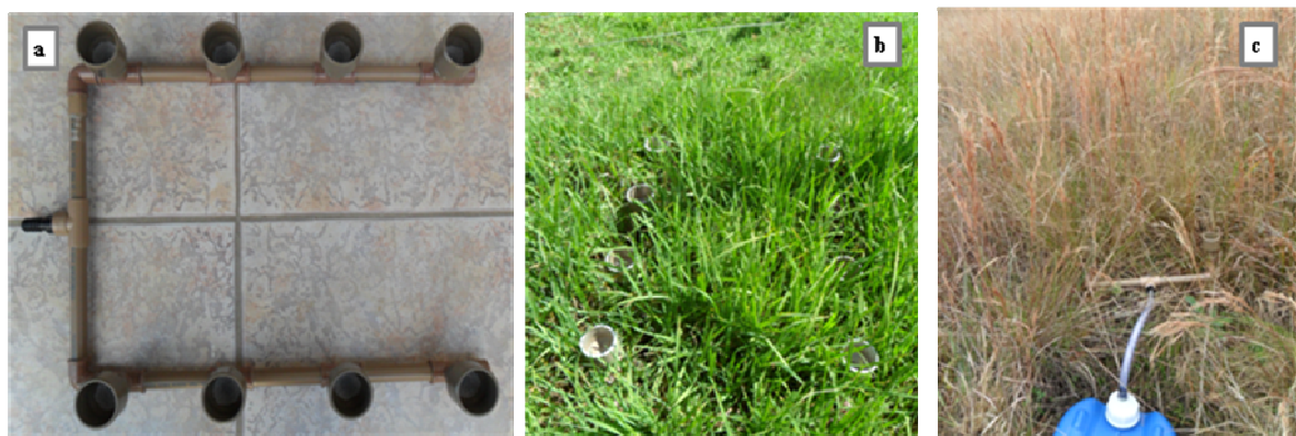
Figura 16. (a) Coletor de precipitação interna de 8 bocas, (b) coletor na área com pasto aveia e (c) coletor no campo nativo.
