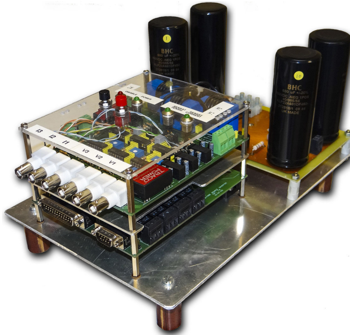
Figura 6.3: Protótipo dos três conversores boost paralelos utilizado nos ensaios experimentais.
