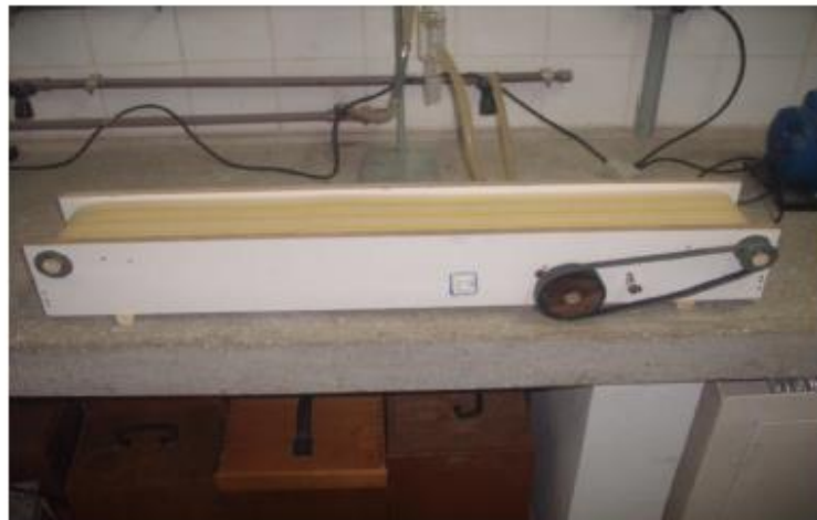
Figura 6. Imagem da esteira usada para o transporte do material.
