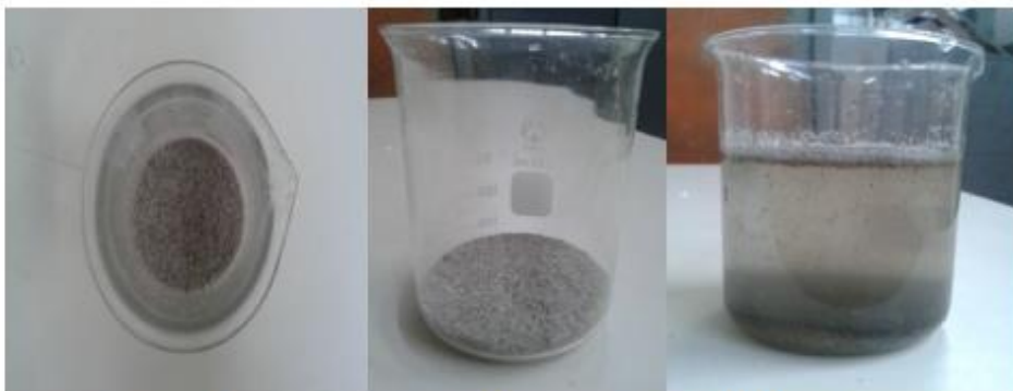
Figura 29. Amostra do coletor de fundo, vista superior (a), vista lateral (b) e flotação (c).
