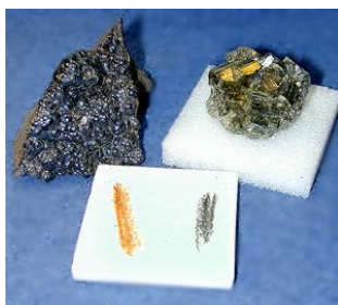
IMAGEM 21: Testando os traços dos minerais.
