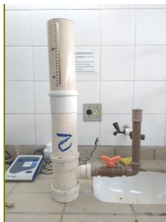
Figura 3.3 – Permeâmetro de carga variável construído
