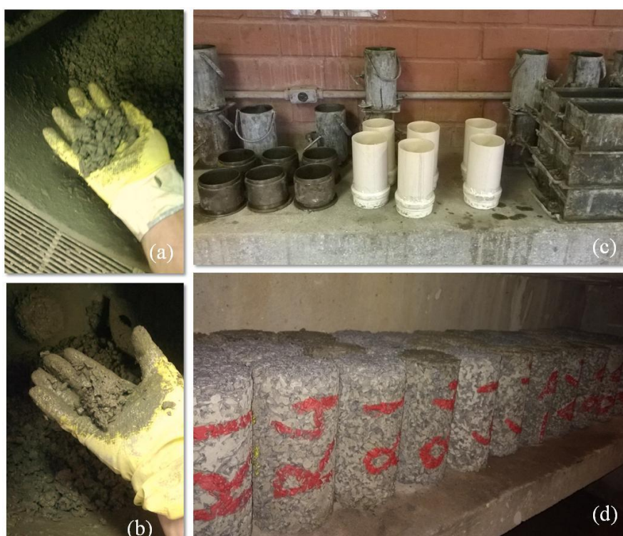
Figura 3.1 – Moldes (a), armazenamento dos CP's (b) e verificação tátil (c); (d)
