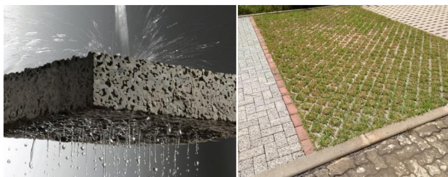
Figura 2.1 – Exemplos de revestimentos permeáveis
