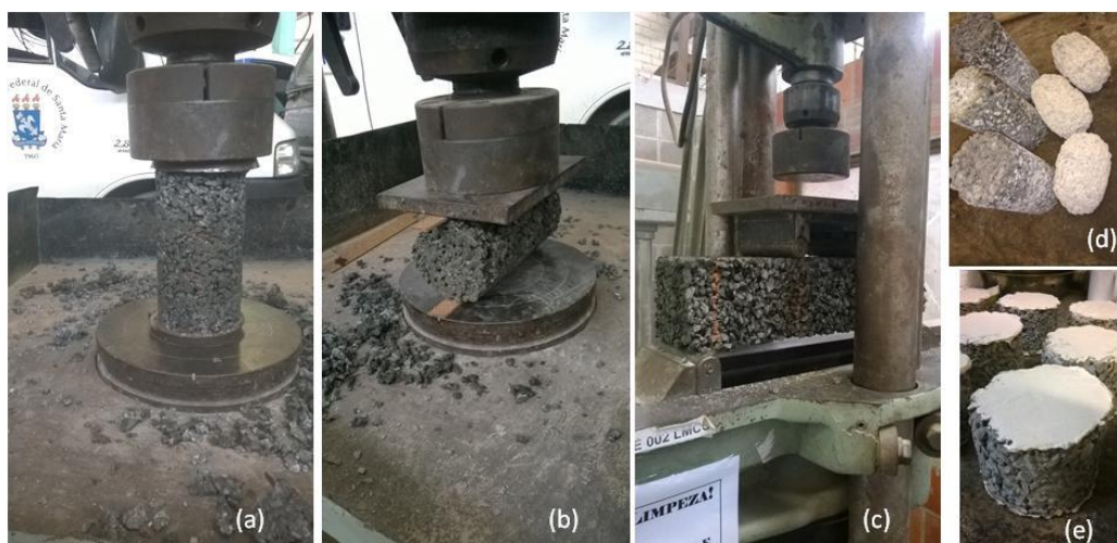
Figura 3.2 – Ensaio de caracterização das propriedades mecânicas (a); (b); (c), aspecto final dos CP's do ensaio de Abrasão (d) e regularização da superfície para ensaio de Módulo de Elasticidade Dinâmico (e)
