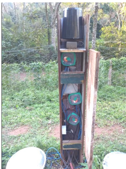
Figura 3.17 – Central com pluviógrafo, fonte e caixas de dados dos sensores
