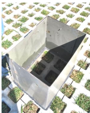
Figura 3.19 – Equipamento retangular e pisograma vedados com massa de calafetar
