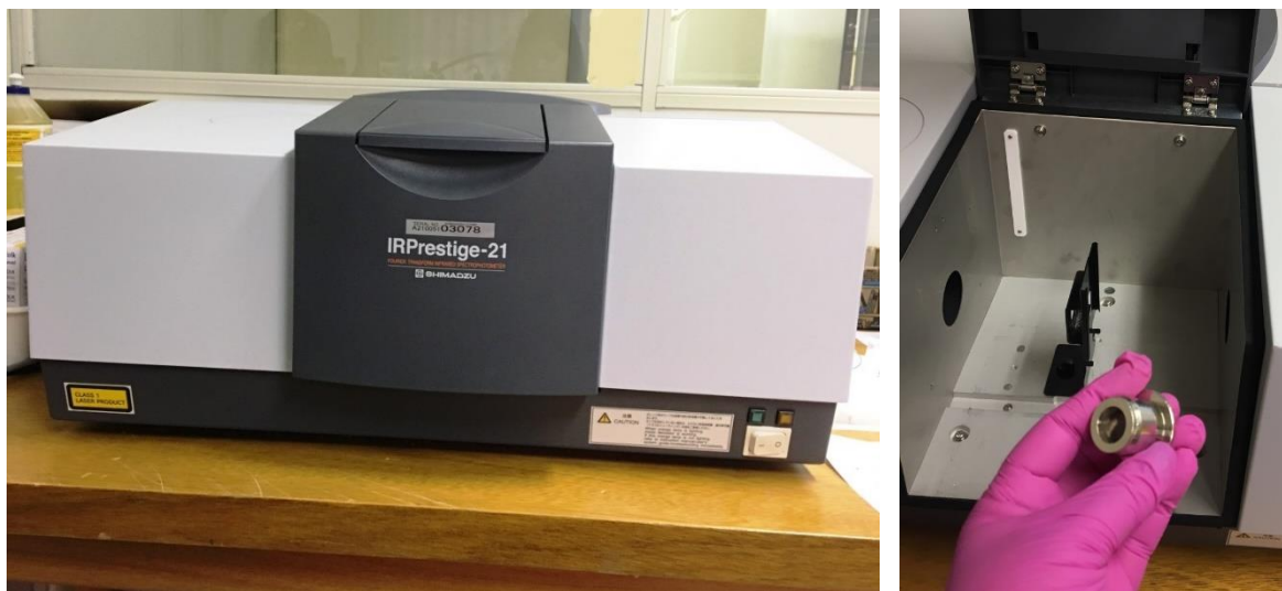
Figura 43 – Equipamento utilizado para análise FTIR à esquerda e porta-amostras à direita
