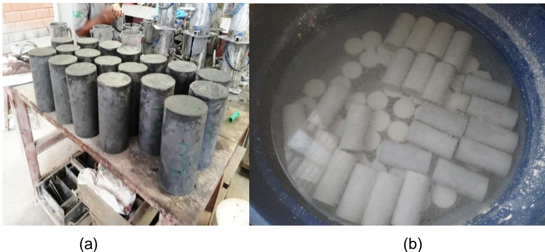
Figura 38 – Corpos de prova de concreto logo após a desmoldagem (a) e cura imersa em água saturada de cal (b)
