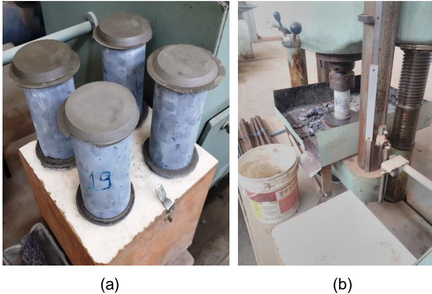
Figura 39 – Capeamento e rompimento na prensa hidráulica
