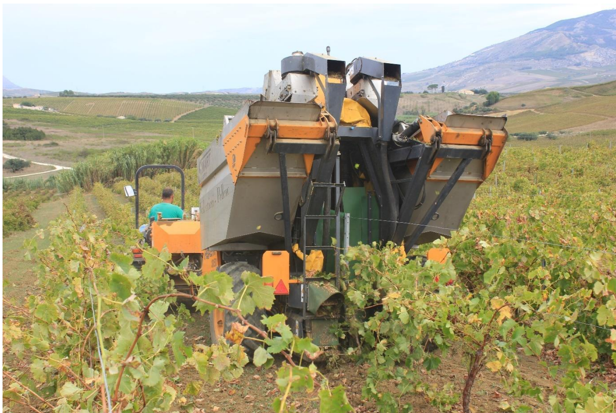
Figura 7 – Colheita mecanizada da uva em Calatafimi Segesta – Sicília – Itália.
