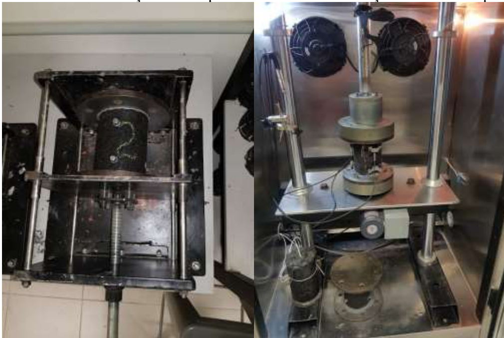
Figura 29 - Processo de fixação das chapas nas amostras e realização do ensaio na prensa
