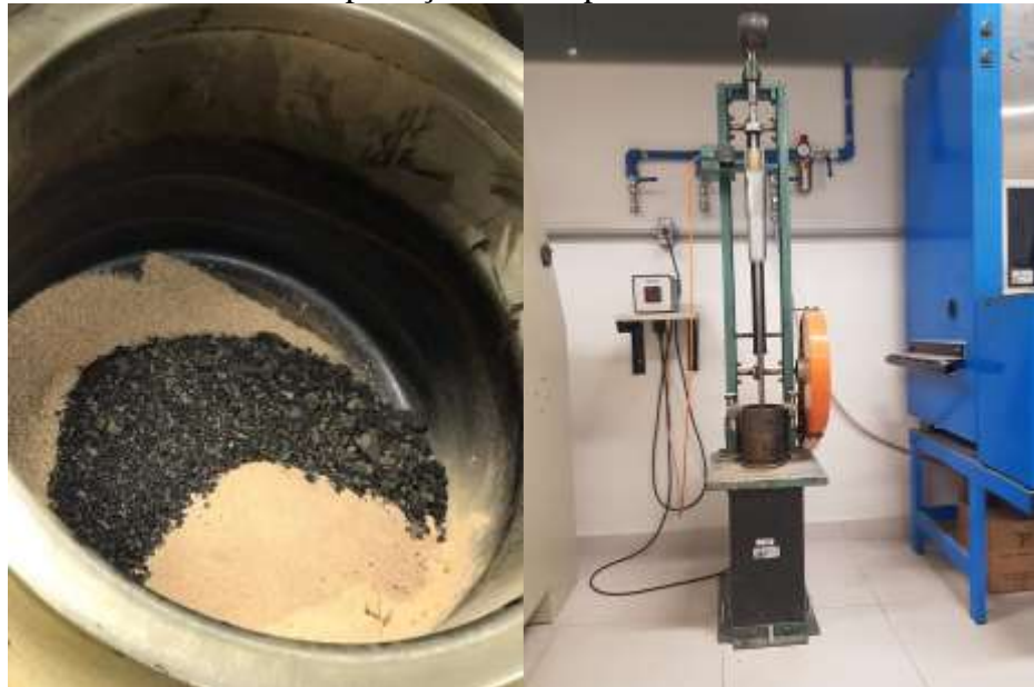
Figura 21 - Processo de mistura e compactação no compactador Marshall
