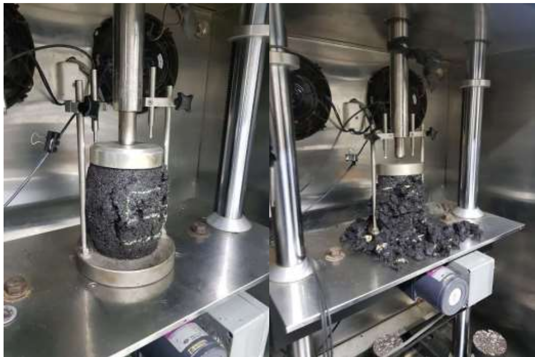
Figura 27 - Exemplo de amostra sofrendo deformação (a) e amostra ao término do ensaio (b)
