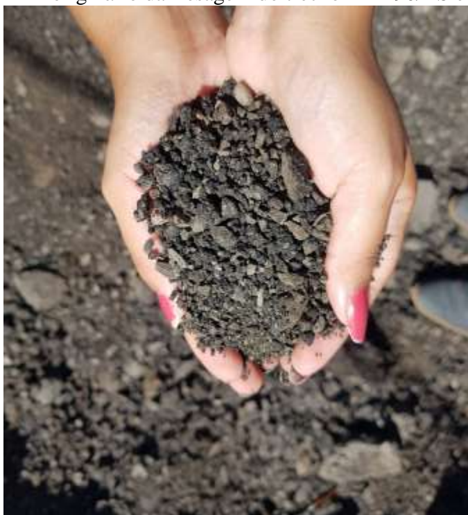
Figura 17 - Detalhes do RAP originário da fresagem do trecho BR-290/RS e BR-116/RS
