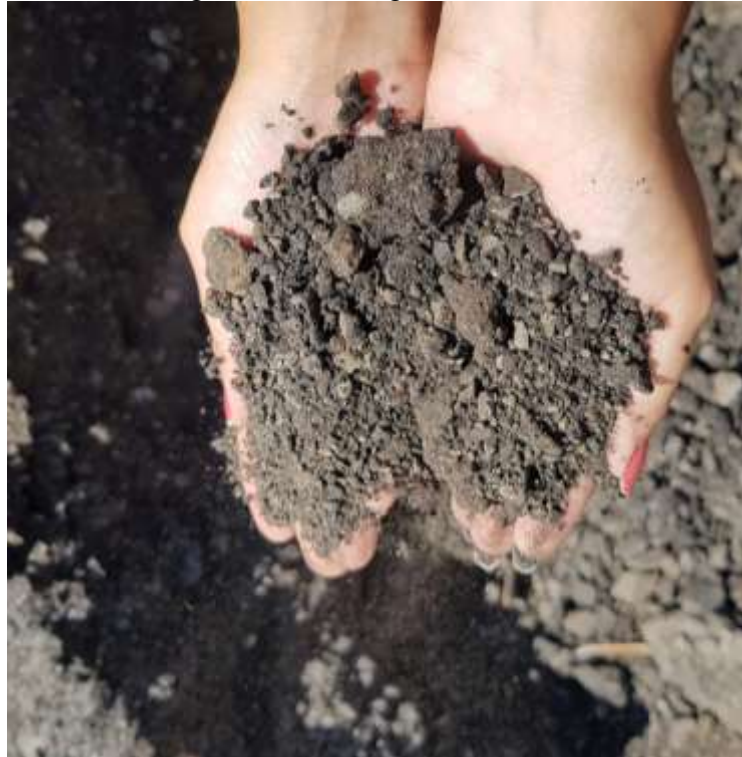
Figura 15 - Detalhes do RAP originário da fresagem do trecho da RS-400
