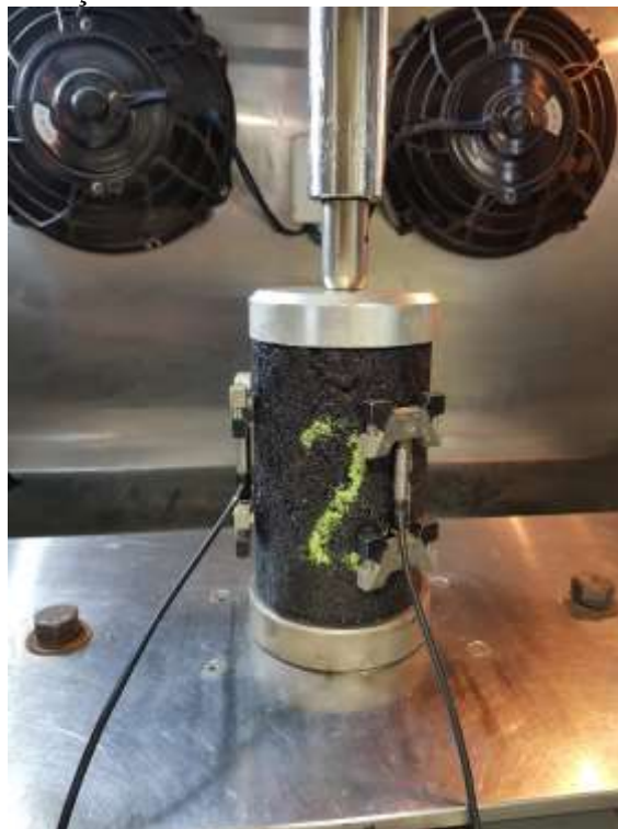
Figura 24 - Detalhe da realização do ensaio de módulo dinâmico
