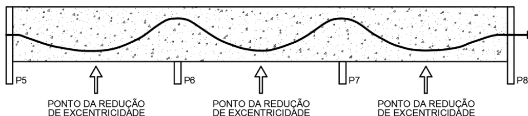
Figura 27 - Pontos de redução da excentricidade para o Base.
