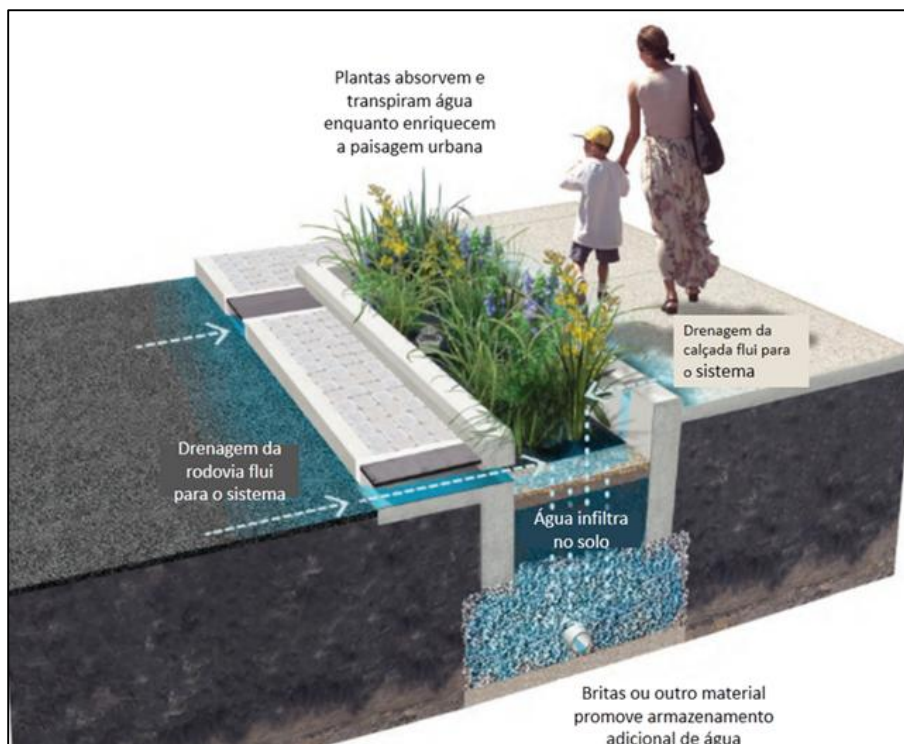
Figura 4 – Sistema de jardim de chuva detalhado
