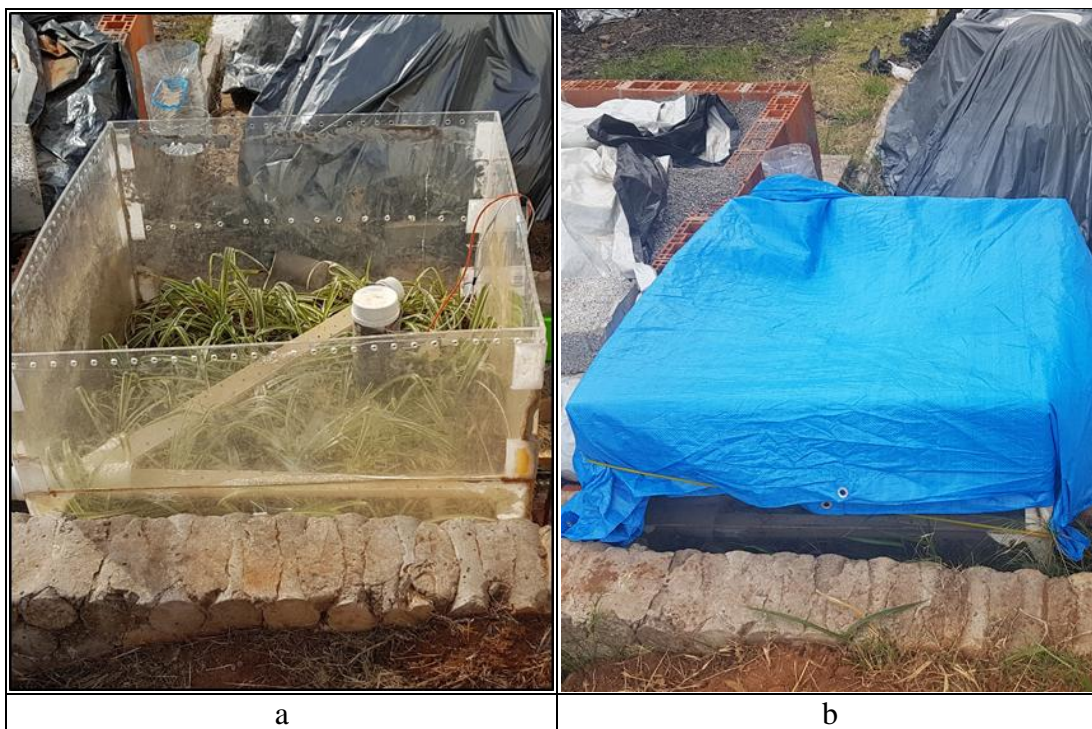
Figura 7 - Célula de biorretenção com diferentes metodologias de contribuição, sendo: a) Tipo 1; e b) Tipo 2
