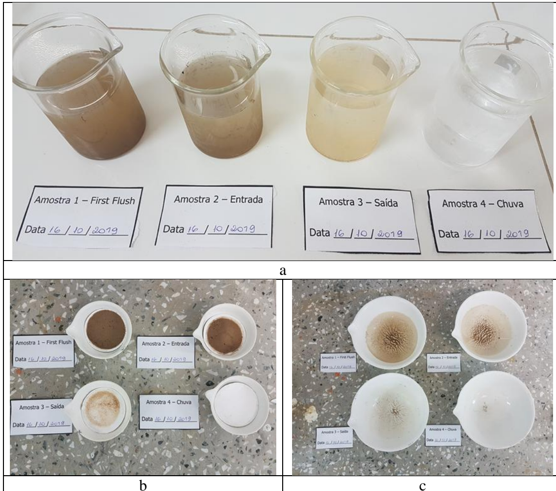
Figura 11 – Comparativo entre as amostras coletadas em monitoramento qualitativo realizado no dia 16/10/2019 referente ao Evento 4, sendo: a) amostras A1, A2, A3 e A4; b) análise de Sólidos Suspensos Totais; e c) análise de Sólidos Dissolvidos Totais
