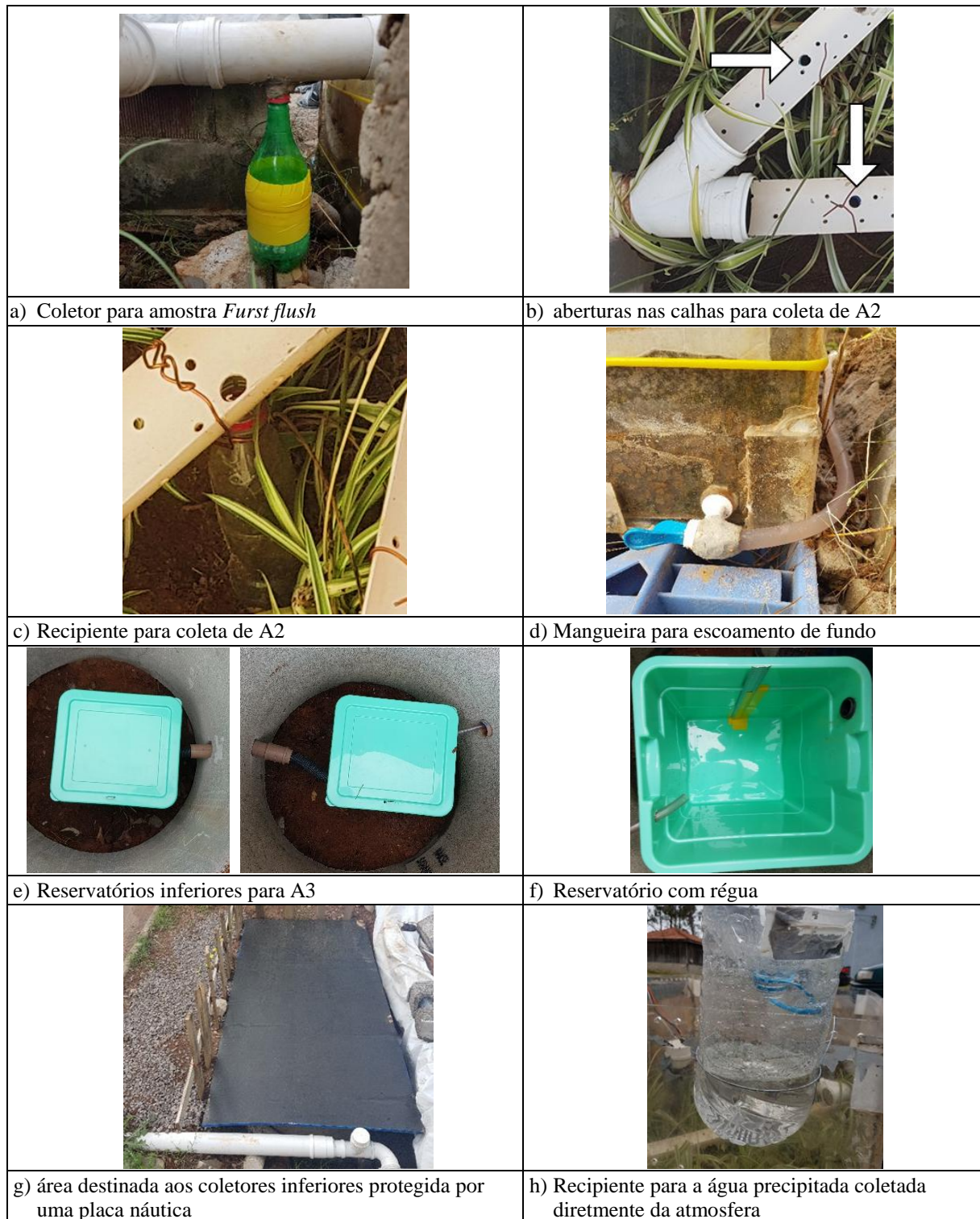
Figura 8 - Sistema de coleta de amostras e verificação quali-quantitativa
