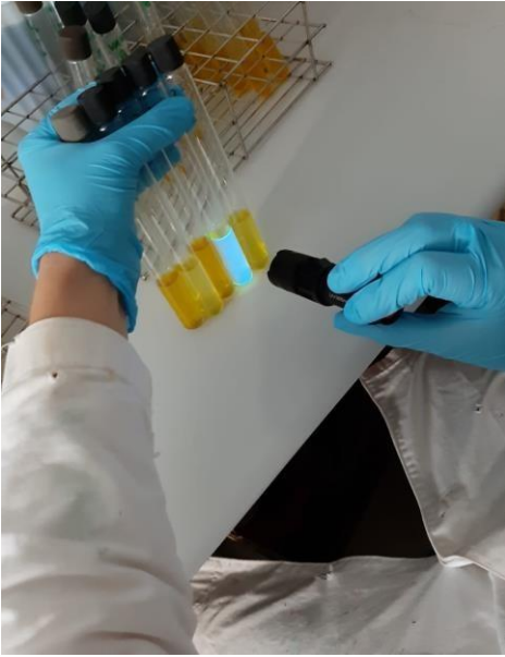
Figura 7 - Leitura das variáveis biológicas Escherichia coli ( E. coli ) e Coliformes Totais.
