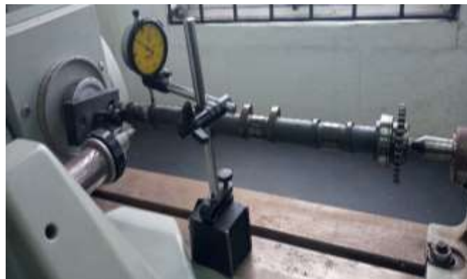
Figura 12 – (a) Setup para medir o perfil da came e (b) simulação no VT-Design®
