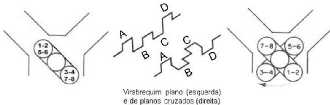
Figura 9 – Comparação entre um virabrequim plano e um de planos cruzados.
