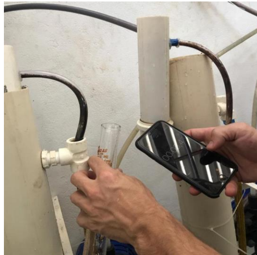
Figura 19 – Aferição da vazão pelo método volumétrico.
