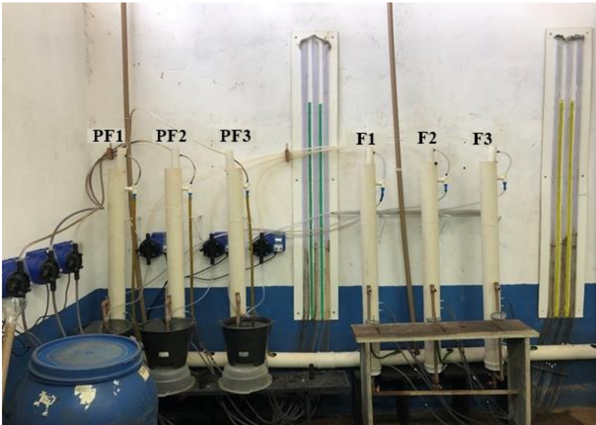
Figura 15 – Conjunto de pilotos de pré-filtração e filtração construídos no LABTAG.
