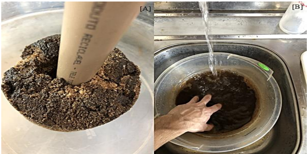
Figura 23 – Demonstração da raspagem e limpeza do meio filtrante.
