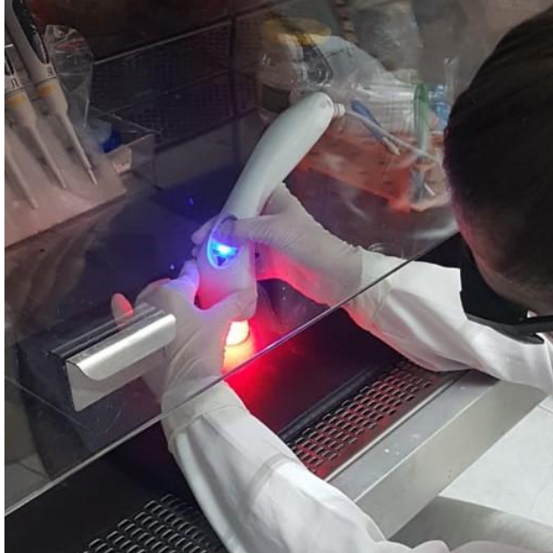
Figura 3 - Irradiação da luz led vermelha no cultivo celular de fibroblastos na placa de Petri sem tampa dentro do fluxo laminar.
