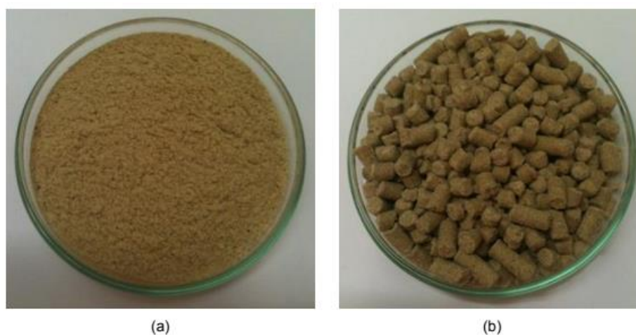
Figura 19 – FA (a) antes da extrusão; (b) após a extrusão.
