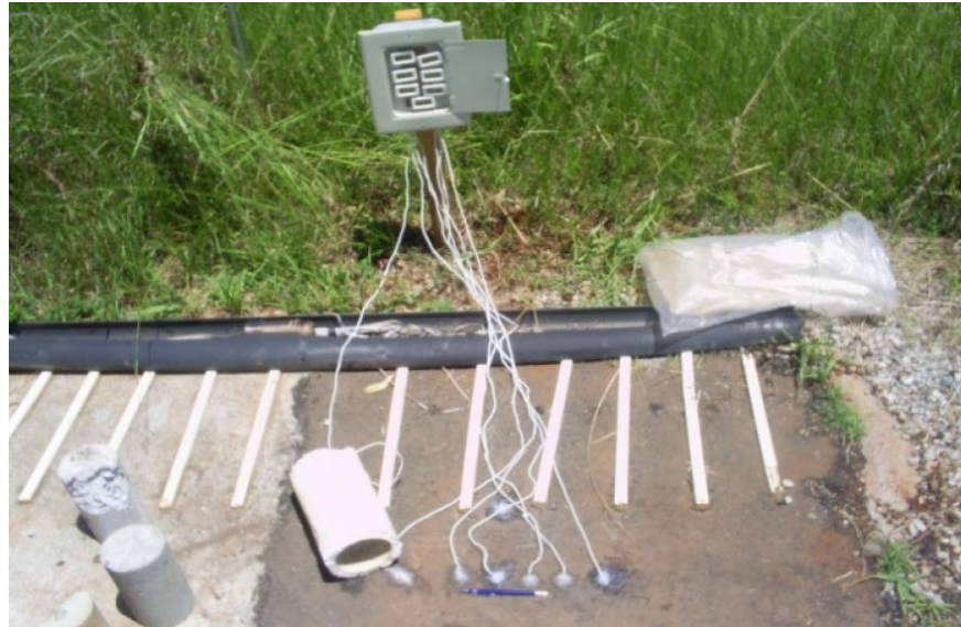
Figura 2.14 - Sensores utilizados por Blass (2011) instalados no pavimento
