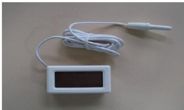
Figura 2.12 - Exemplo de sensor digital de temperatura usado por Blass (2011)
