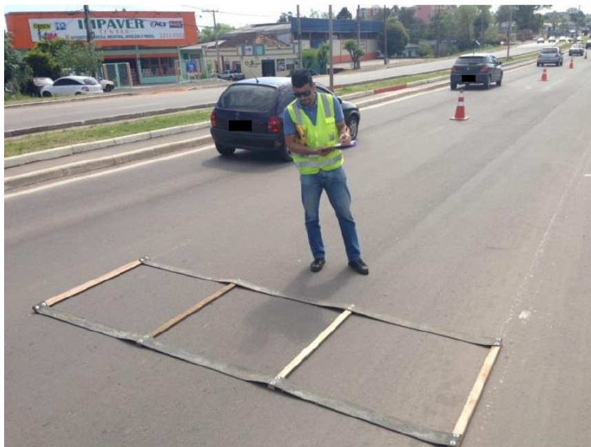
Figura 3.14 - Procedimento de medição em campo de AT
