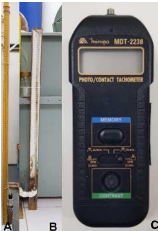
Figura 3 - A) Tensiômetro de coluna de mercúrio; B) Régua medidora para a leitura do nível do tanque (LNT); C) Tacômetro digital utilizado para medições da rotação do eixo do motor.
