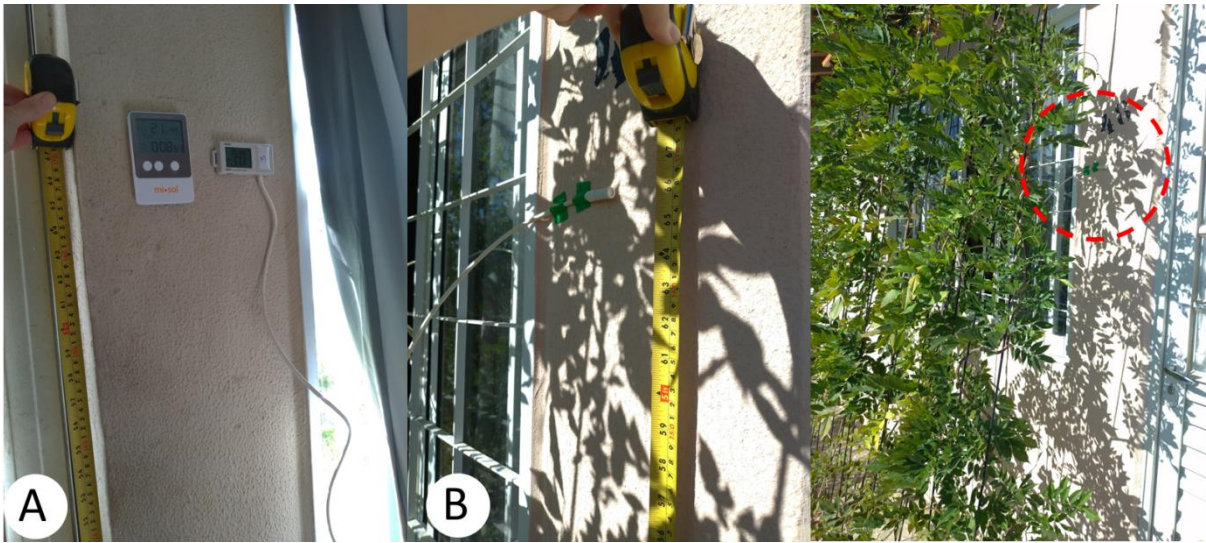
Figura 21 - Posição do sensor externo com extensor
