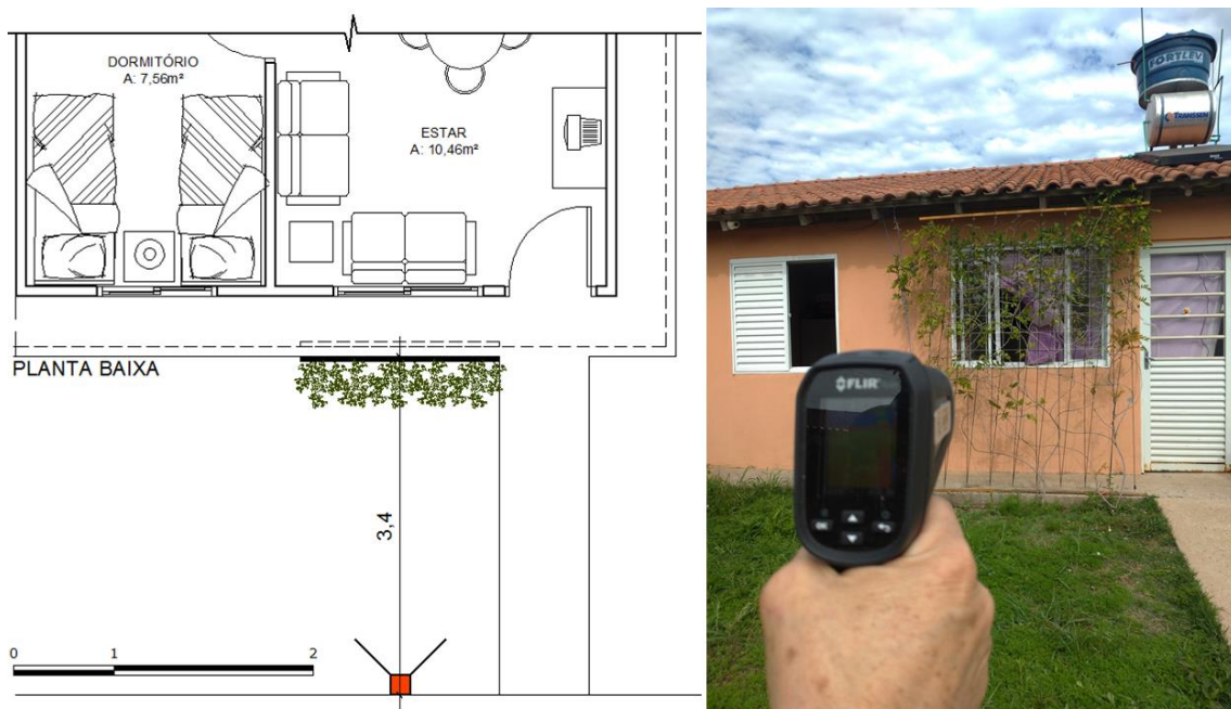
Figura 25 - Posicionamento da câmera termográfica e registro de imagem
