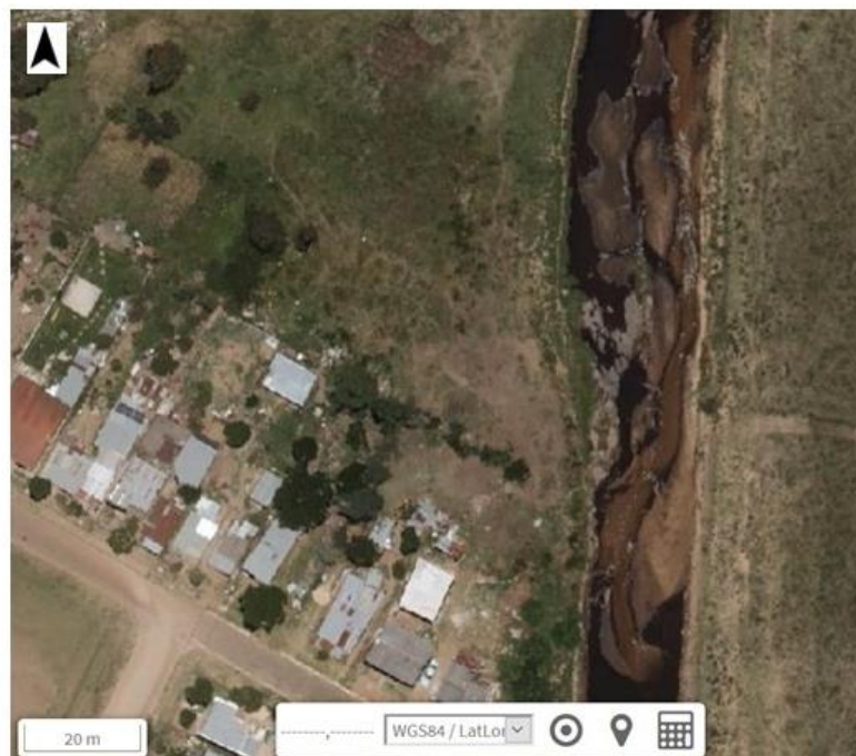
Figura 58 - Sedimentação e estreitamento do canal Cuñapirú
