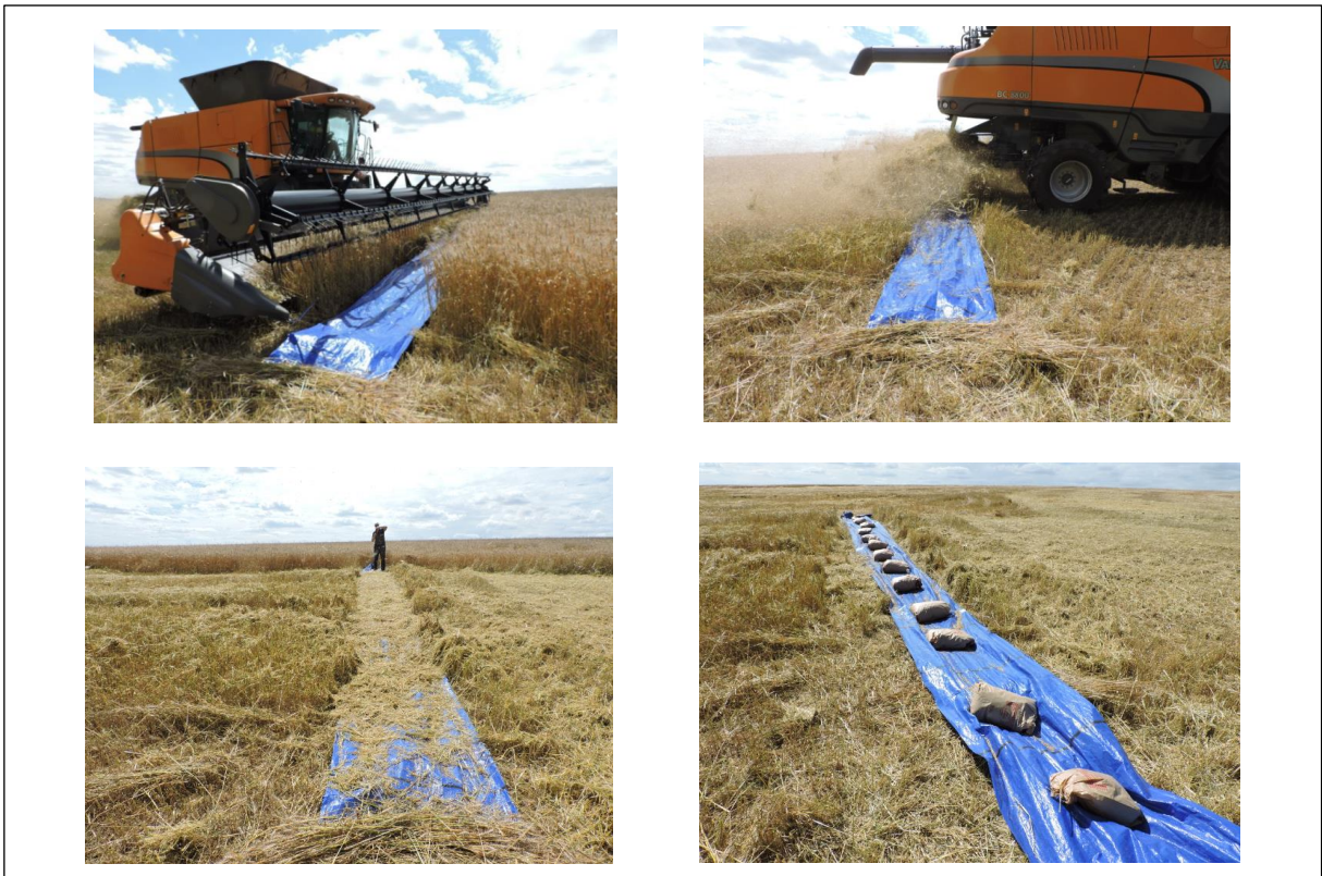
Figura 10 – Esquema para medição da distribuição da palha realizada pela colhedora
