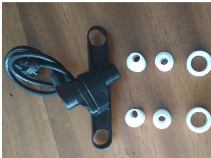
Figura 3.11: Sensor de posição do virabrequim e buchas para montagem na posição original e posição de 2,5 graus adiantada.
