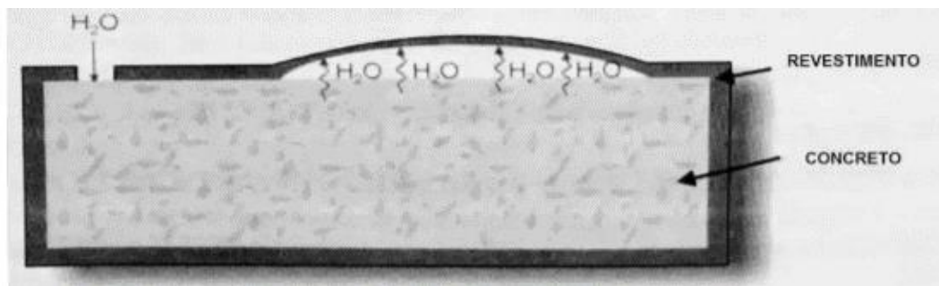
Figura 18: Umidade penetra o concreto sem o revestimento, após revestido encontra dificuldade para evaporar.
