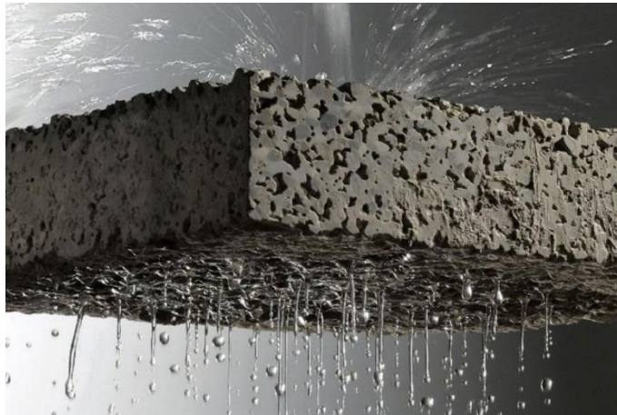
Figura 08- Demonstração da porosidade do concreto.
