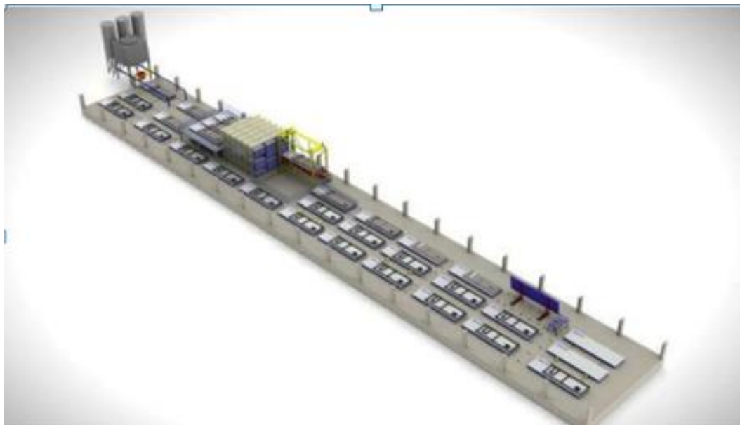
Figura 66– Imagem da fábrica automatizada de concreto da Urban 3D
