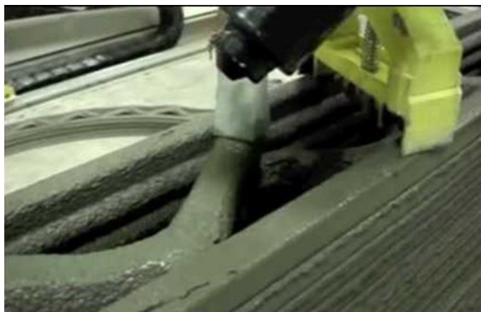
Figura 11– Detalhe da altura da camada
