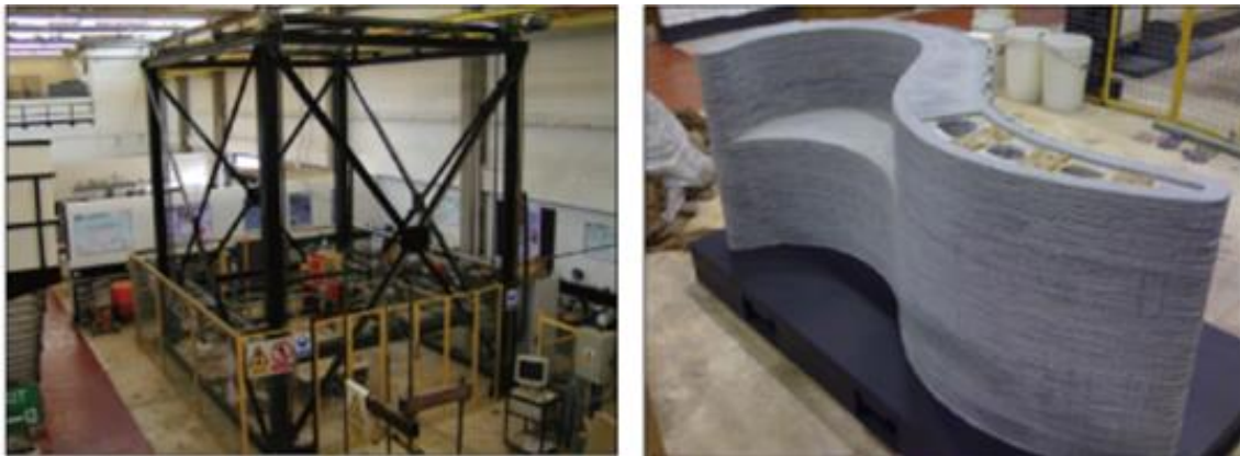
Figura 14– Impressora e peça impressa utilizando a tecnologia Concrete Printing
