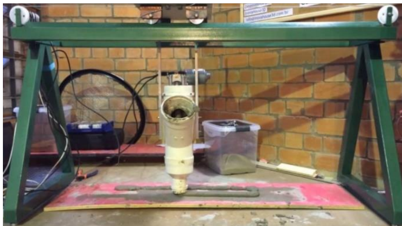
Figura 64– Protótipo da impressora 3D de concreto desenvolvida pela InovaHouse3D
