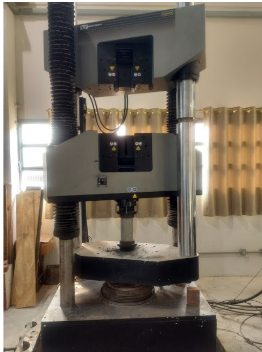
Figura 19 - Ensaio de resistência a compressão axial sendo realizado
