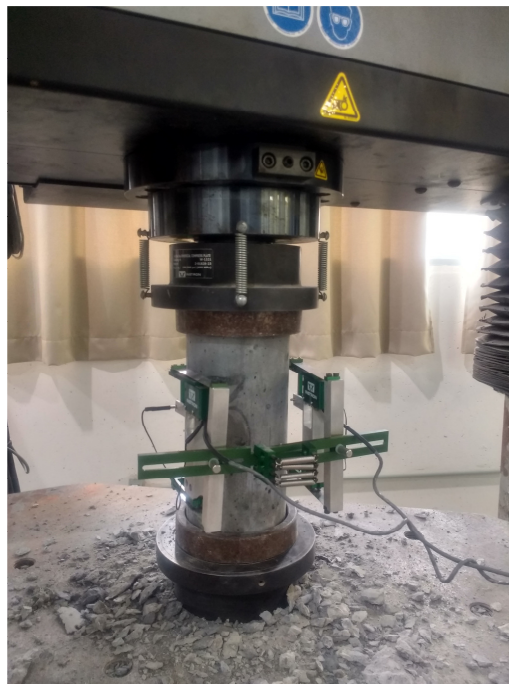
Figura 20 - Corpo de prova com LVDT posicionado
