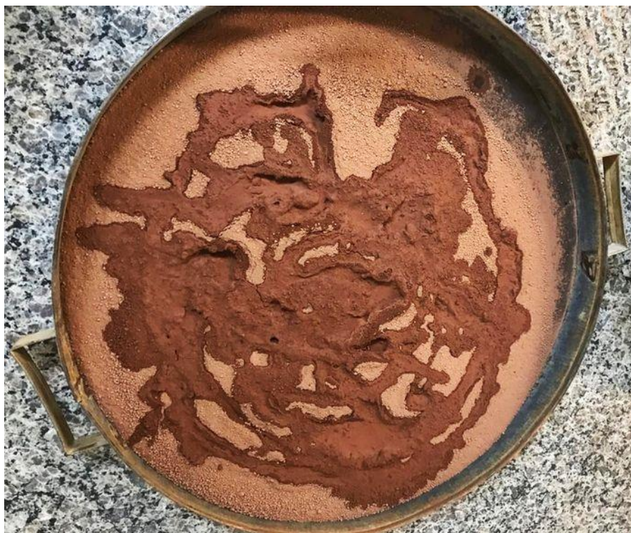
Figura 10 - Processo de Homogeneização da Mistura na Umidade Ótima
