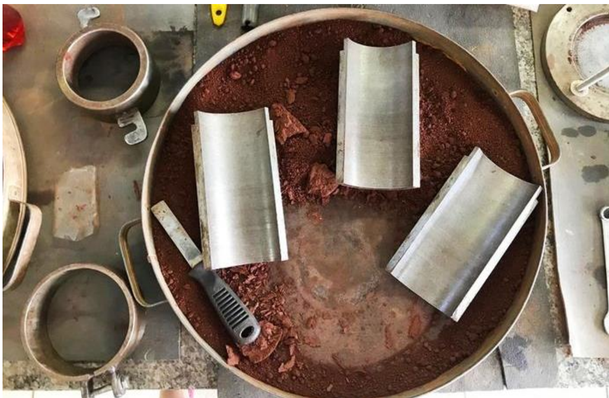
Figura 9 - Cilindro tripartido utilizado para a moldagem dos corpos de prova
