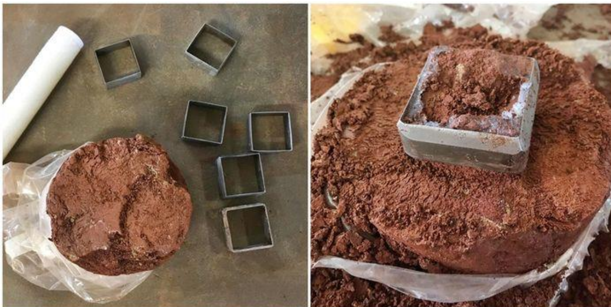
Figura 13 - Moldagem dos corpos de prova para o ensaio de cisalhamento direto
