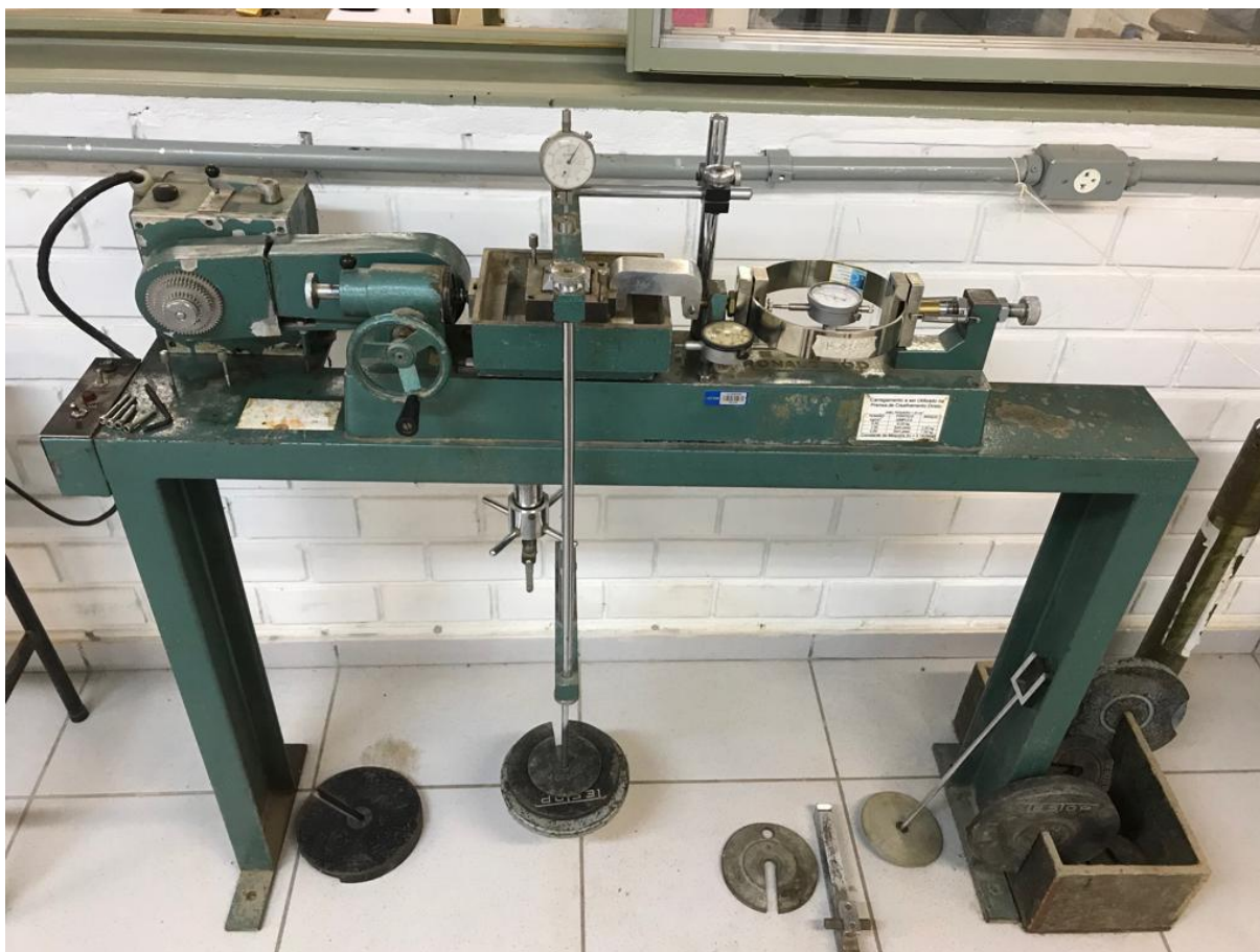
Figura 15 – Aparelho utilizado para o ensaio de cisalhamento direto
