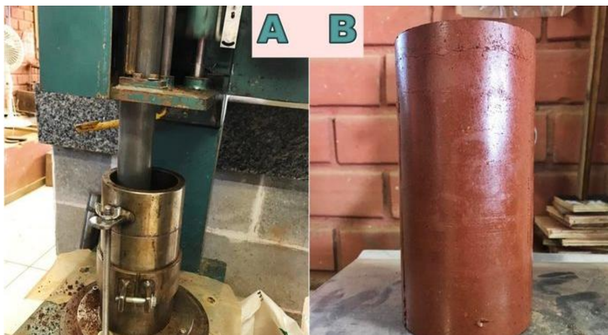
Figura 11 - Moldagem dos corpos de prova no cilindro tripartido. (a) Compactação; (b) Corpo de prova moldado.
