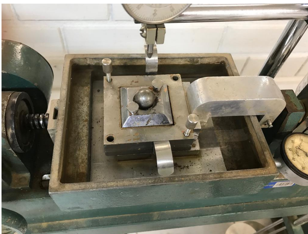
Figura 18 – Aparelho Montado para o ensaio de Cisalhamento Direto
