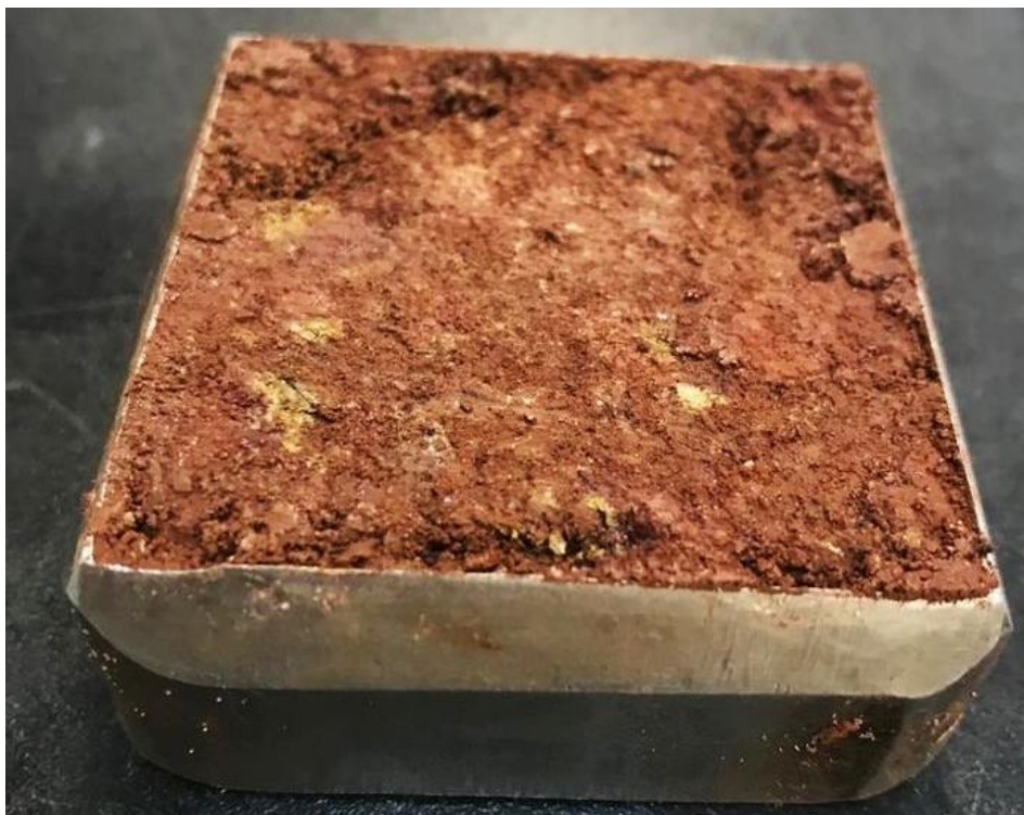
Figura 14 - Amostra pronta para o ensaio de cisalhamento direto
