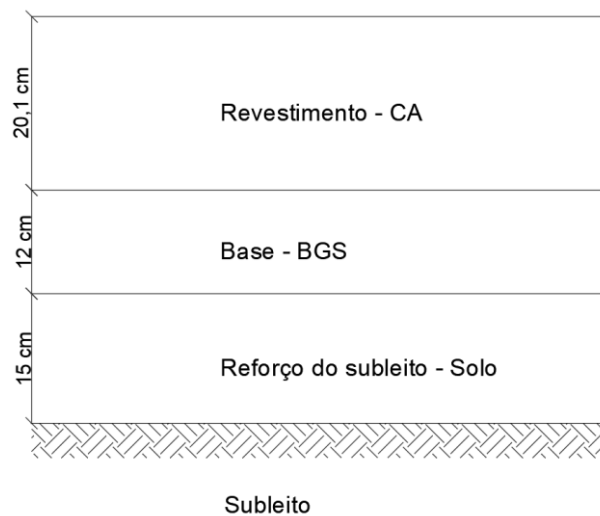
Figura 4.5 – Representação das camadas constituintes da estrutura com reforço do subleito dimensionada pelo MeDiNa
