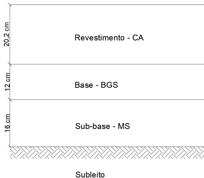
Figura 4.9 – Representação das camadas constituintes da estrutura com sub-base dimensionada pelo MeDiNa
