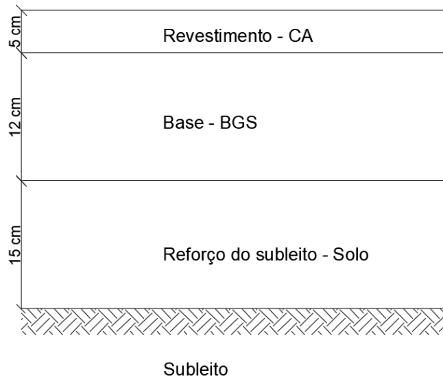
Figura 4.10 – Representação da estrutura com reforço do subleito dimensionada com o MeDiNa
