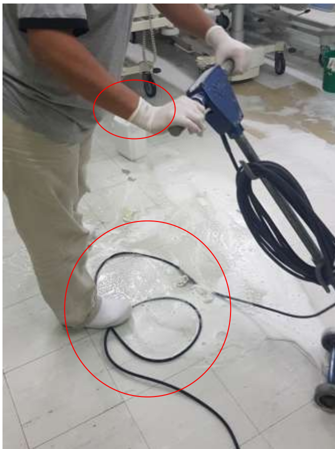
Figura 15 – Utilização incorreta da máquina lavadora e os riscos existentes
