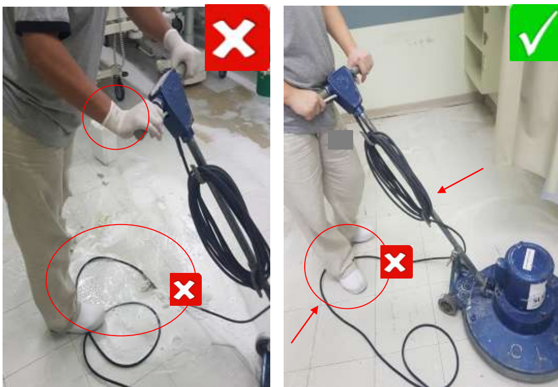
Figura 19 – Postura corporal dos punhos e mãos (incorreta e correta) na utilização da máquina lavadora
