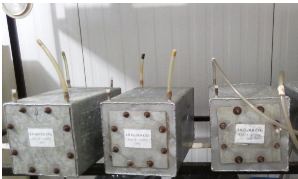
Figura 1- Minisilos herméticos utilizados no armazenamento de sementes e grãos de feijão, Santa Maria, 2020.
