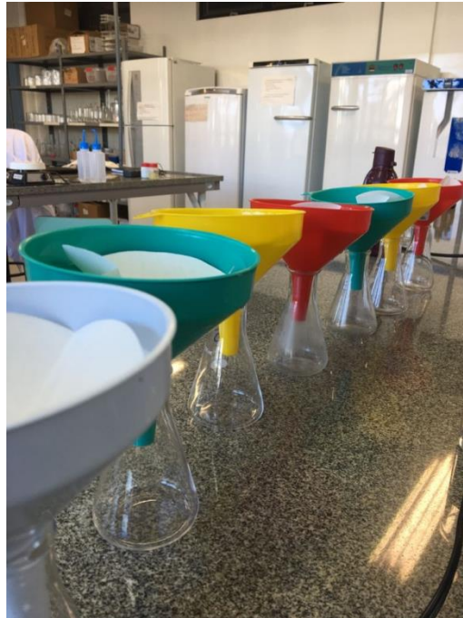
Figura 9 Filtração após ensaio de jar test
