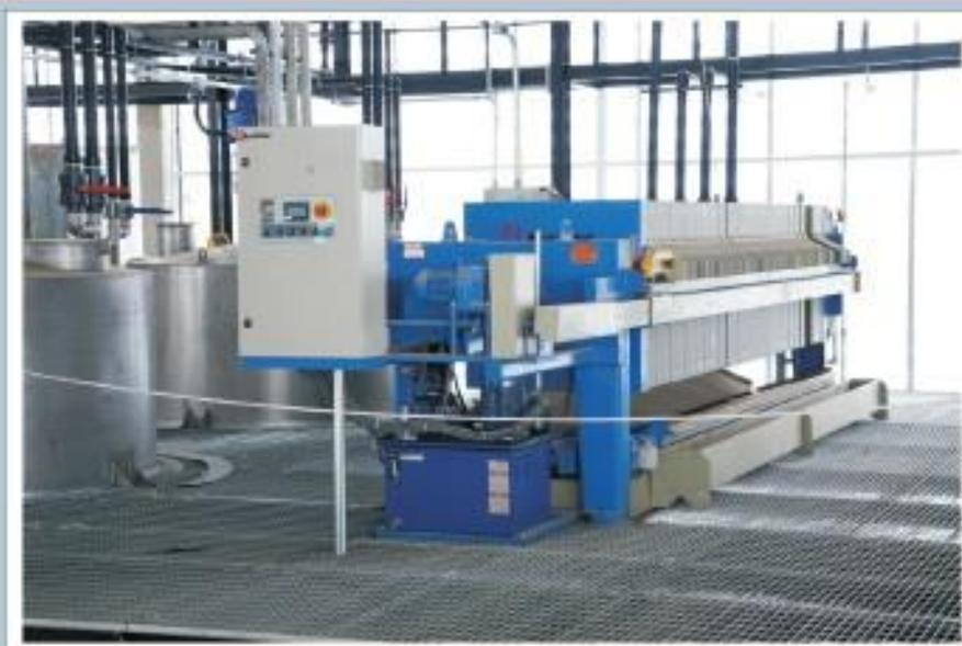
Os Filtros Prensa Tecitec permitem alta eficiência de deságue do lodo de Estações de Tratamento de Efluentes Industriais, esgotos ou polpas de processos industriais nos segmentos de mineração, alimentícia, farmacêutica, petroquímica, cerâmica, tintas e pigmentos, celulose, galvânica, bebida, óleo mineral - vegetal entre outras.
