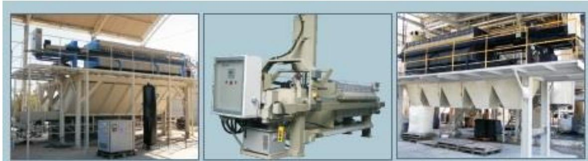
Filtro Prensa automático sobre plataforma      Filtro Prensa automático com lavagem de lamas      Filtro Prensa automático com Ferril de descarga de torta
