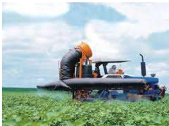
Figura 1 – Pulverizador Jacto Falcon Vortex® utilizado para aplicar os tratamentos
