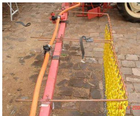
Figura 2 – Cortina de correntes pendentes adaptada a uma barra de pulverização
