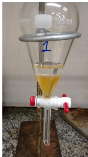
Figura 13 – Separação da camada de n -heptano, contendo o ergosterol da membrana do fungo, da camada aquosa em funil de separação.
