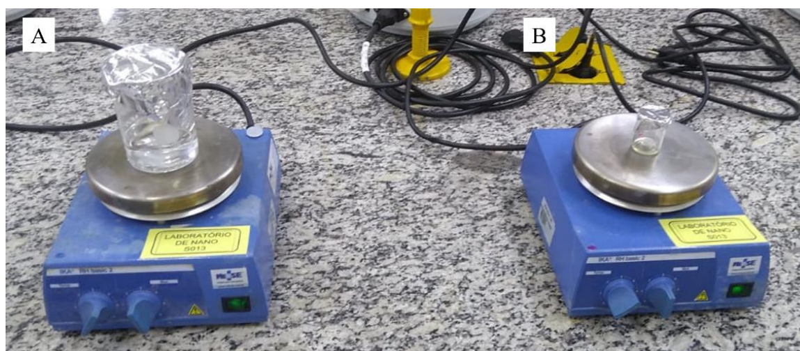
Figura 10 – Homogeneização das fases aquosa (A) e orgânica (B), a serem usadas para a preparação da nanoemulsão do OE de Piper gaudichaudianum , em agitador magnético.
