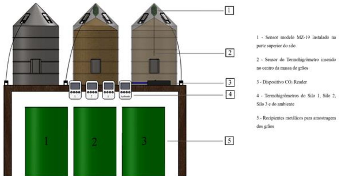
Figura 9 - Protótipos de silos verticais utilizados para o armazenamento de grãos de milho.
