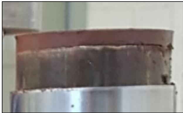
Figura 21 – CP sendo extraído após compactação, d=40\text{mm} e h=10\text{ mm}
