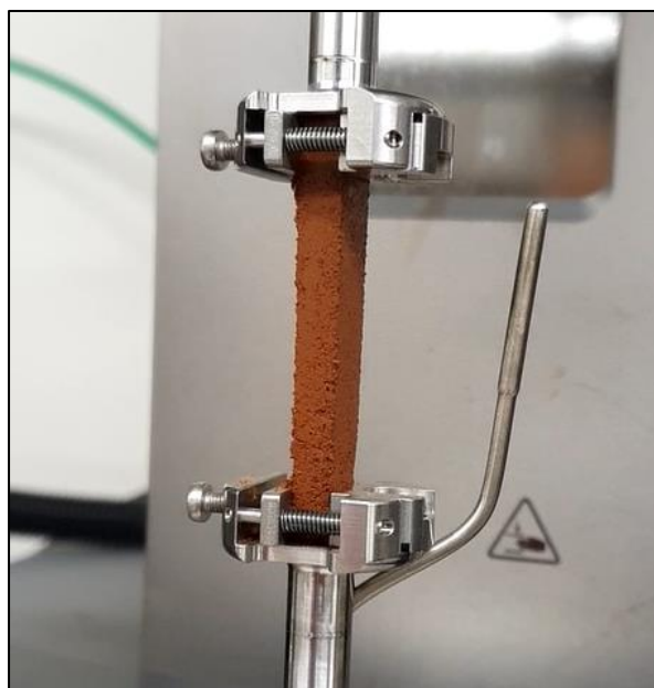
Figura 28 – Destaque aos ganchos usados para torção de barras sólidas
