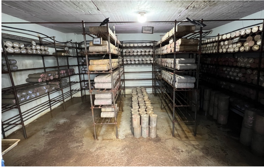
Figura 17 - Câmara úmida utilizada para cura dos corpos de prova.
