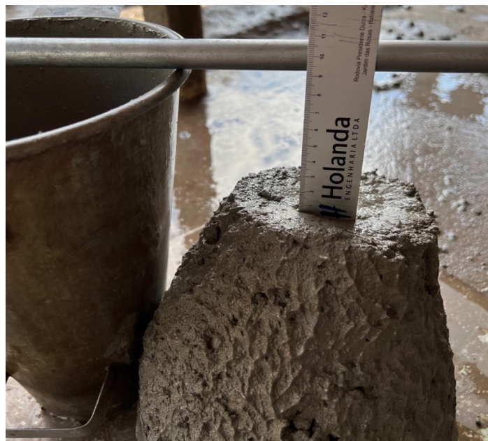
Figura 25 - Verificação do abatimento do Traço Experimental.
