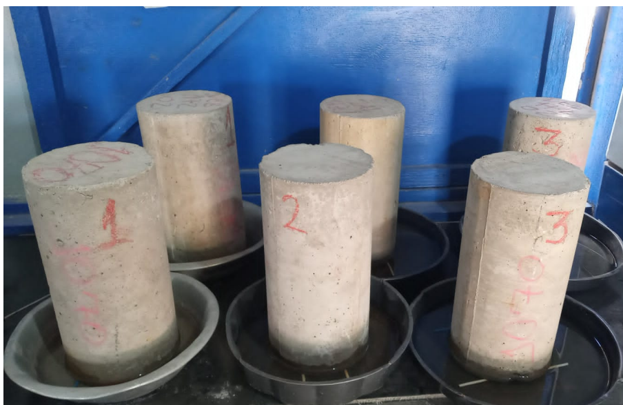
Figura 26 - Execução do ensaio de absorção por capilaridade.
